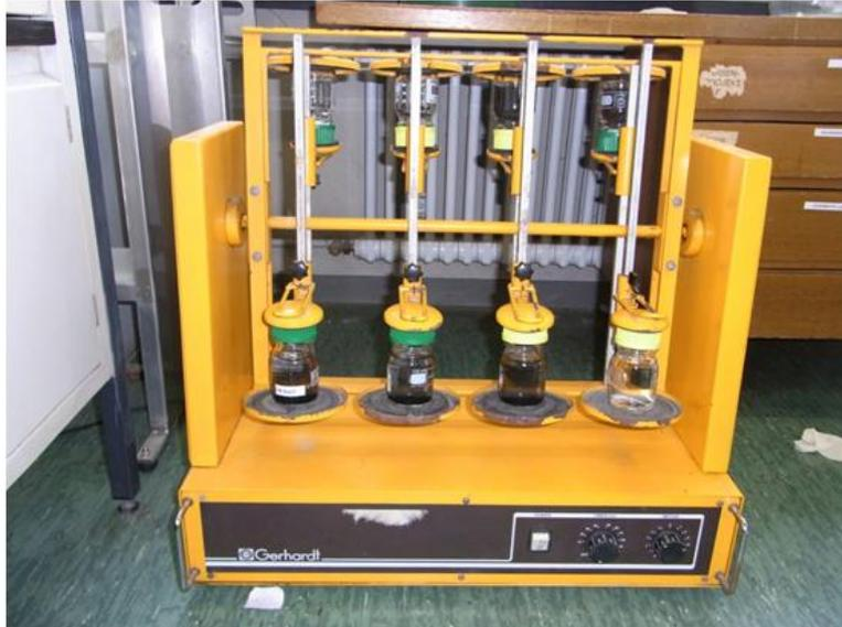
**Abbildung 7: Für die Versuche eingesetzter Überkopfschüttler**
