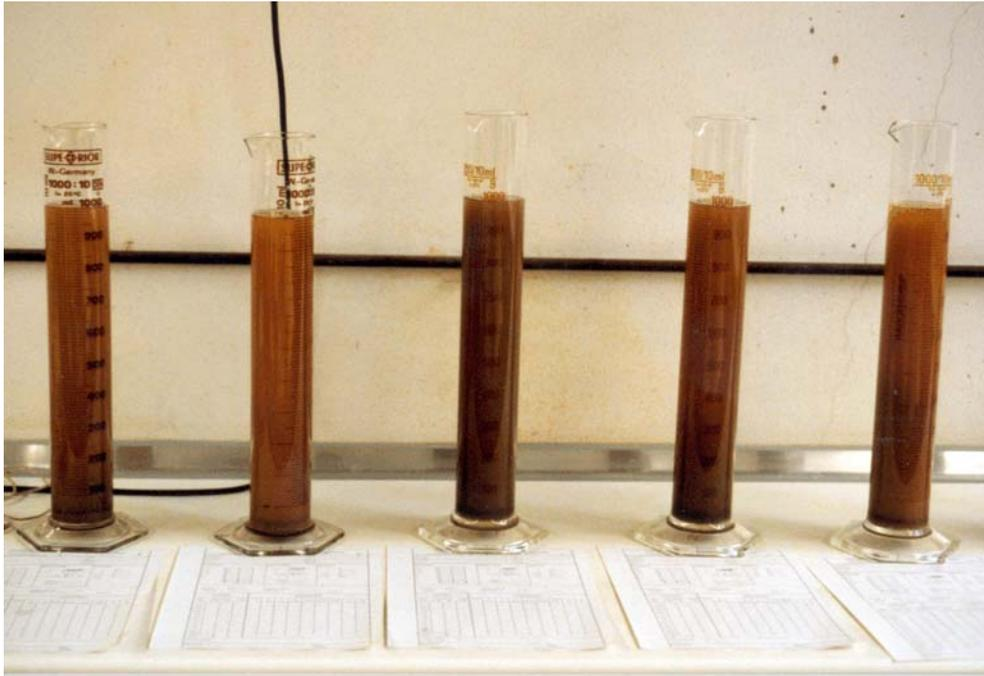
Abbildung 20: Messzylinder während der Sedimentationsanalyse.
