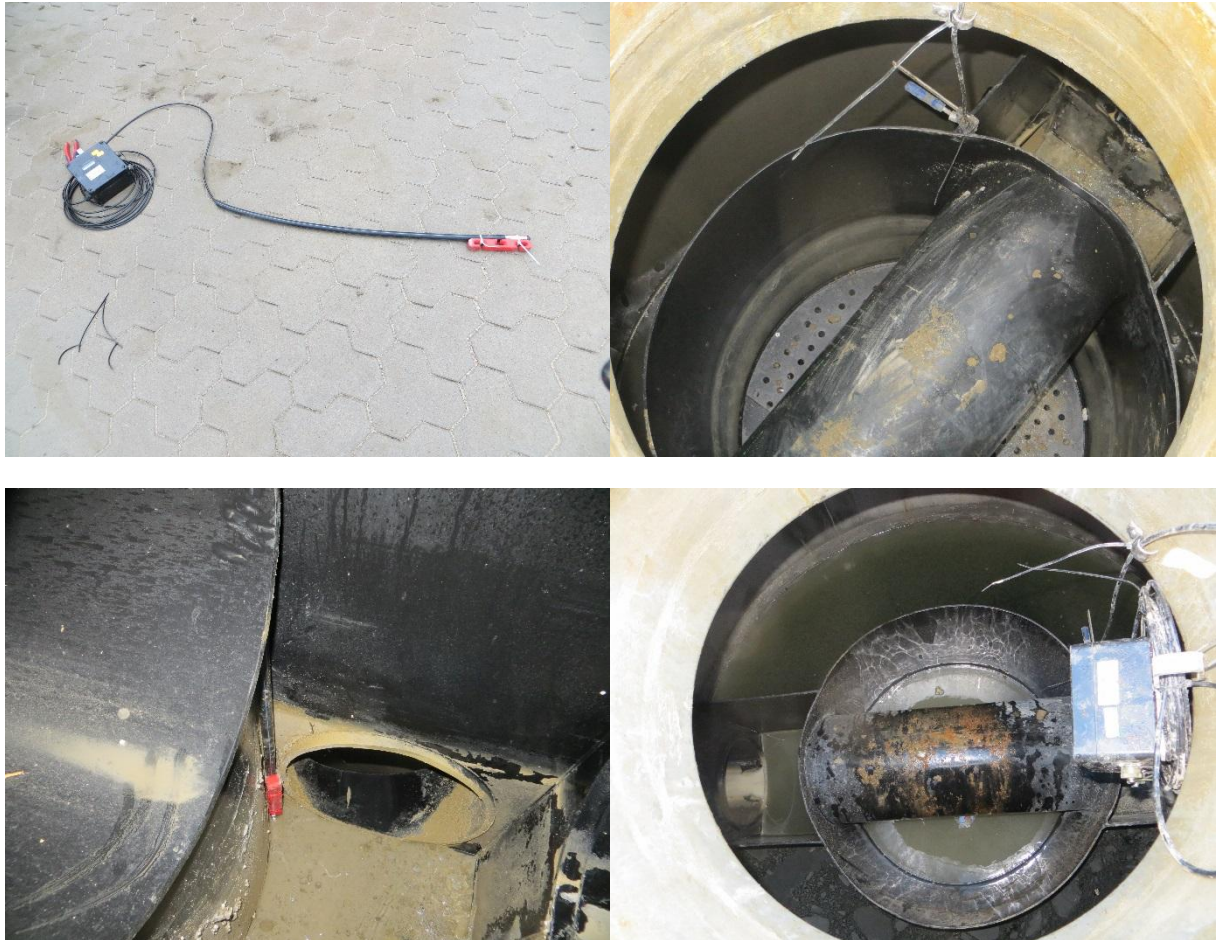
Abbildung 10: Drucksonde mit Datenlogger im ViaDrop30/150
