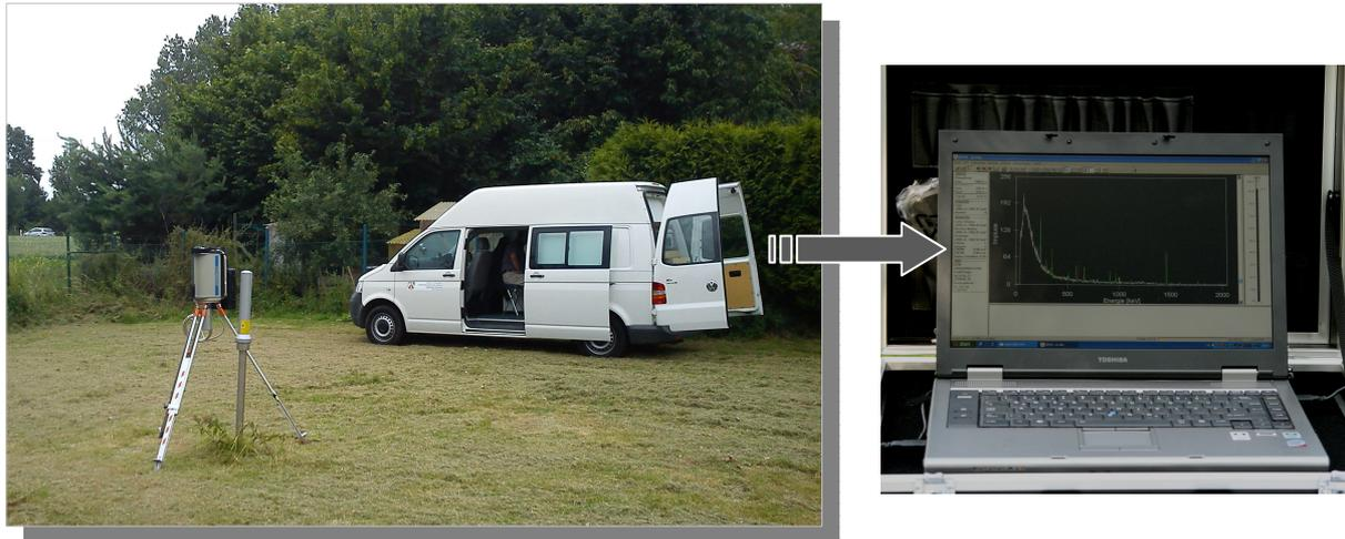
**Abbildung 5.6:** In-situ-Messung an einer ODL Station auf einem Gelände des THW.
