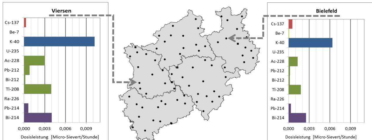
**Abbildung 5.7:** In-Situ-Gammaspektrometrie in NRW. Die Punkte zeigen die 75 Messstellen verteilt über die fünf Regierungsbezirke. Beispielhaft dargestellt sind Messergebnisse aus dem Jahr 2017 an den Messstellen in Viersen (14.11.2017) und Bielefeld (17.08.2017). Außer Cäsium-137 sind alle gemessenen Radionuklide natürlichen Ursprungs (siehe auch Tabelle 5.3).
