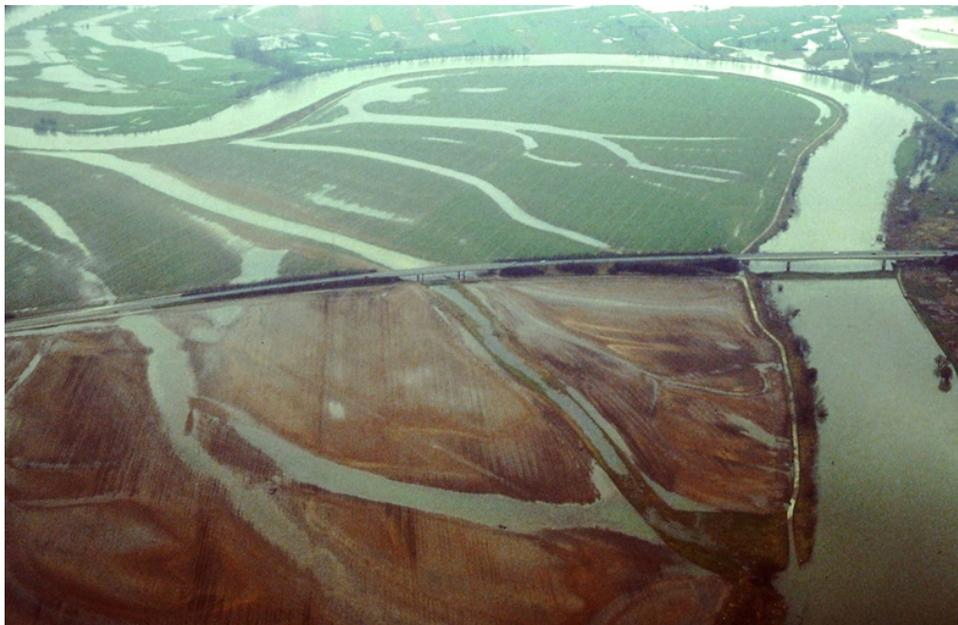
**Abbildung 58:** Wasserführende Flutrinnen durchziehen bei stärkeren Hochwasserereignissen die intensiv genutzte Auenlandschaft, hier im Lüchtringer Bogen zwischen Hörter und Holzminden – auch die Mittelweseraue in Petershagen wird durch diverse Flutrinnen und -mulden gegliedert (Foto: UIH Ingenieur- und Planungsbüro)
