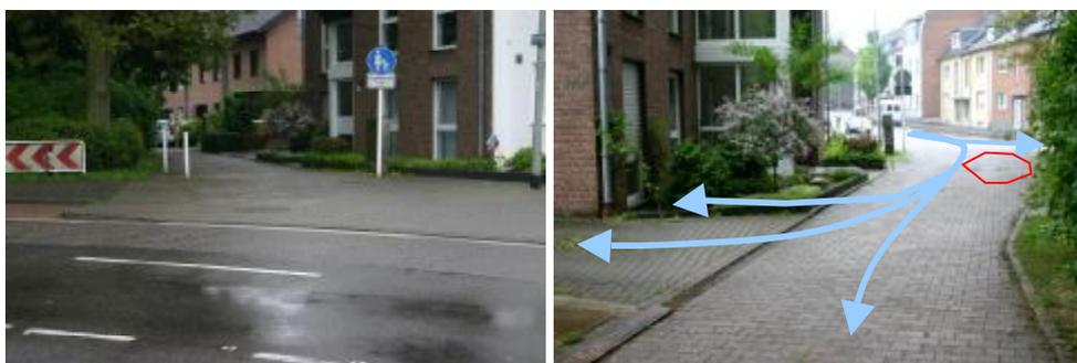
Bild 32 Ansichten der Häuserzugänge im Bereich des Geländetiefpunkts und Fließwege bei Wasseraustritt aus der Kanalisation bzw. Überlastung der Straßeneinläufe (Ortstermin April 2009)
