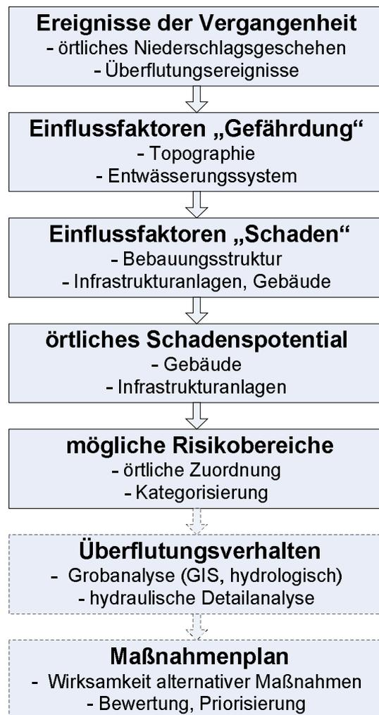
Bild 12 Bearbeitungsschritte zur Analyse und Bewertung der örtlichen Überflutungsgefährdung (nach Schmitt, 2011)
