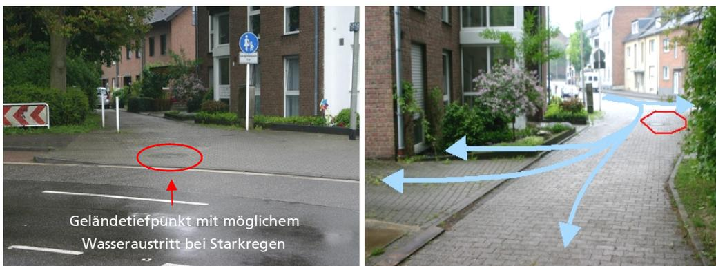
Bild 14 Erstbewertung oberflächlicher Fließwege und der Nutzungen (tiefliegende Fenster, Garageneinfahrt) in einem überflutunggefährdeten Bereich (Bilder: Dr. Pecher AG)
