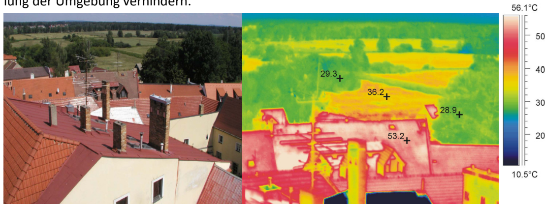
Abb. 2.6: Vergleich der Oberflächentemperatur von versiegelten und bewachsenen Flächen (Pokorný 2010)
