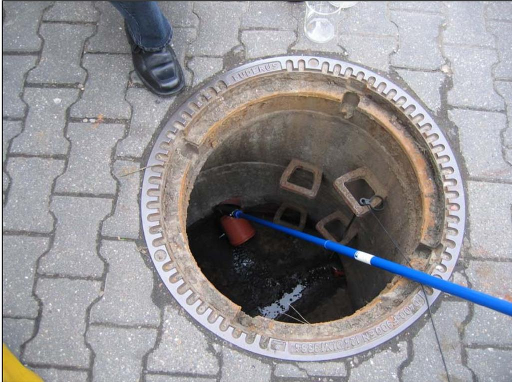
Abb. 3.5-1: Probenahme mit Probenahmearm
