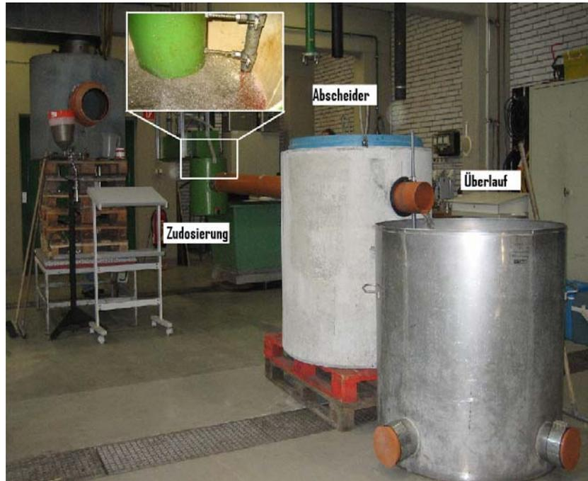
Abb. 3.3-2: Zudosierung der leichten Phase zum Wasser und Einlauf in den Abscheider
