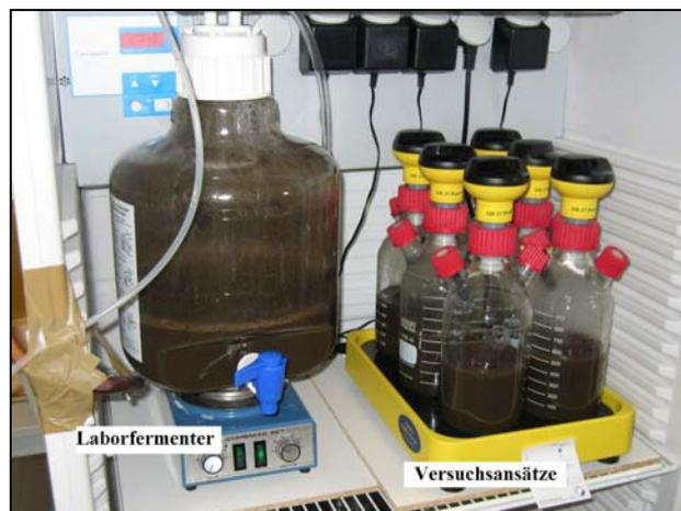
Abb. 3.6-4: Messsystem zum anaeroben Abbau mit Laborfermenter
