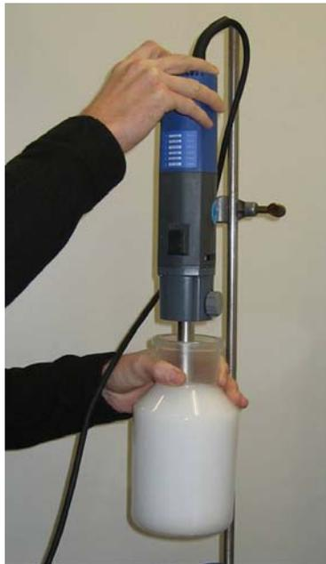
Abb. 3.6-2: Dispersionsvorgang bei den dieselhaltigen Wasserproben
