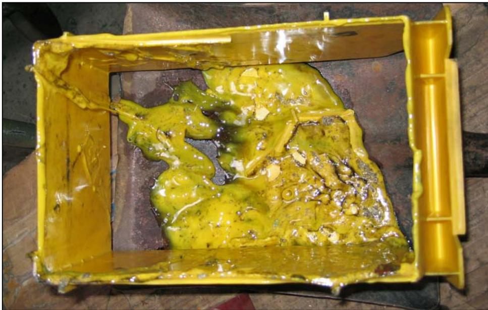
Abb. 4.5-1: Von Biodiesel beschädigte PVC-Wanne
