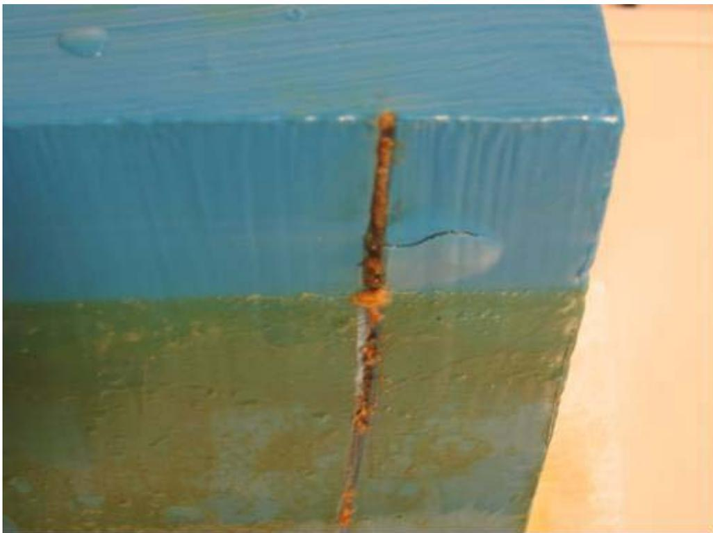
Abb. 4.5-4: Abgelöste Beschichtung auf dem Betonprüfkörper
