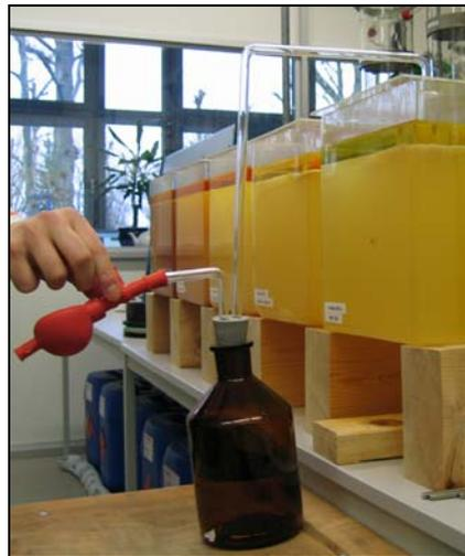
Abb. 3.4-3: Probenahmeverrichtung für die Wasserphase der Standversuche
