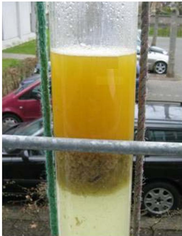
Abb. 4.2-24: Schichtbildung bei den Filterversuchen
