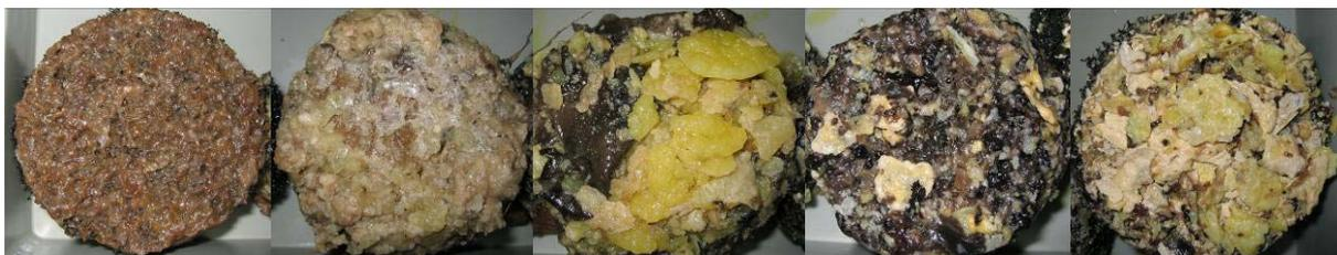
Abb. 4.2-25: Koaleszenzmaterial mit den abgesetzten Feststoffen (von links nach rechts: 0% BD, 5% BD, 20% BD, 60% BD und 100% BD)
