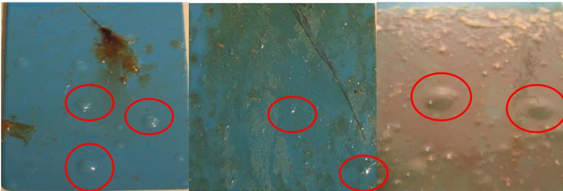
Abb. 4.5-3: Blasenbildung bei Beschichtung B in 0 %, 20 % und 100 % Biodiesel
