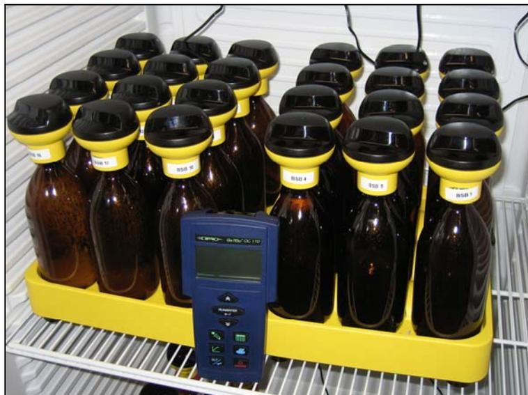
Abb. 3.6-1: BSB-Messsystem von WTW
