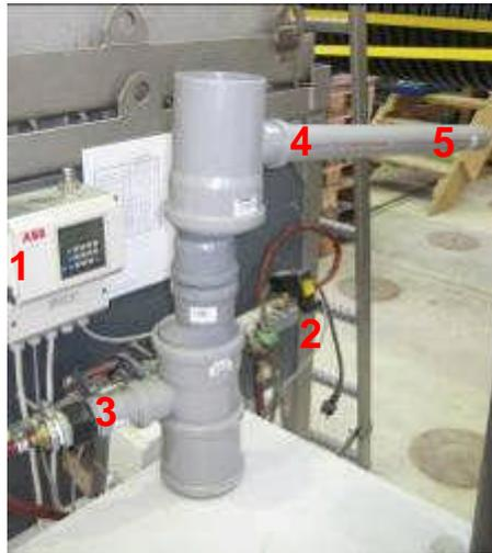
Abbildung 9: Aufbau zur Ermittlung des Rückhalts von Schwermetallen (hier INNOLET®) an einem Filterabschnitt (Versuchsanlage 2).
