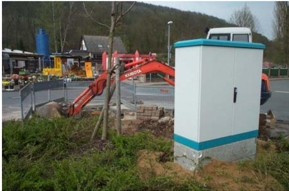
Abbildung 18: Messschrank zur Aufnahme des Q-Loggers und der Probenehmer
