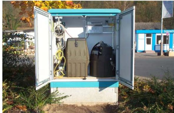
Abbildung 19: Messschrank mit Probenehmern. Der Q-Logger wurde im Fuß des Messschrankes unterhalb der Probenehmer untergebracht
