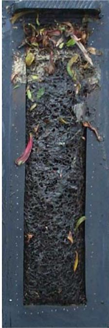
Abbildung 23: Koaleszenzfilters während der Reinigung des Centrifloel-Systems nach dem Probebetrieb
