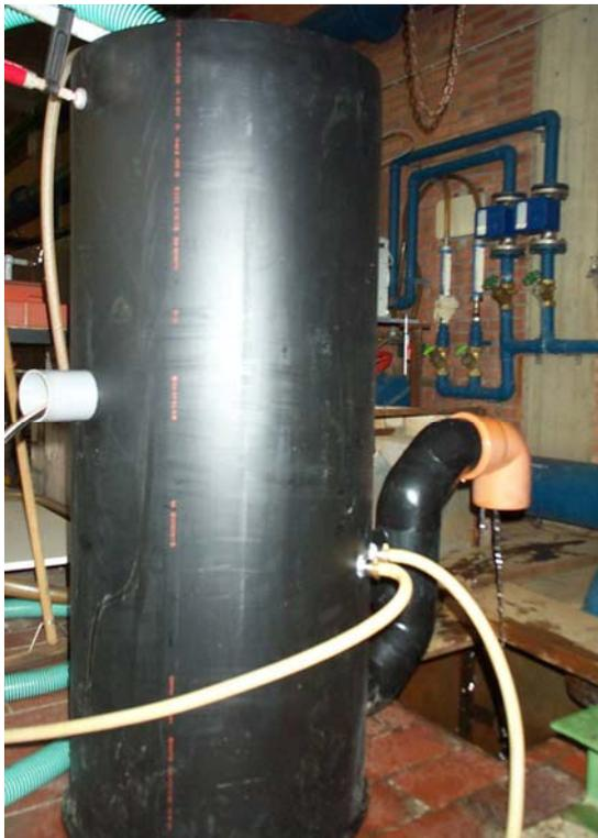
Abbildung 13: Schläuche für Probenahmen am Straßenablauf
