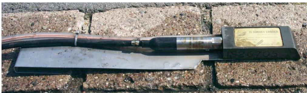
Abbildung 12: Messkopf des Q-Loggers, montiert auf Trägerplatte aus Edelstahl
