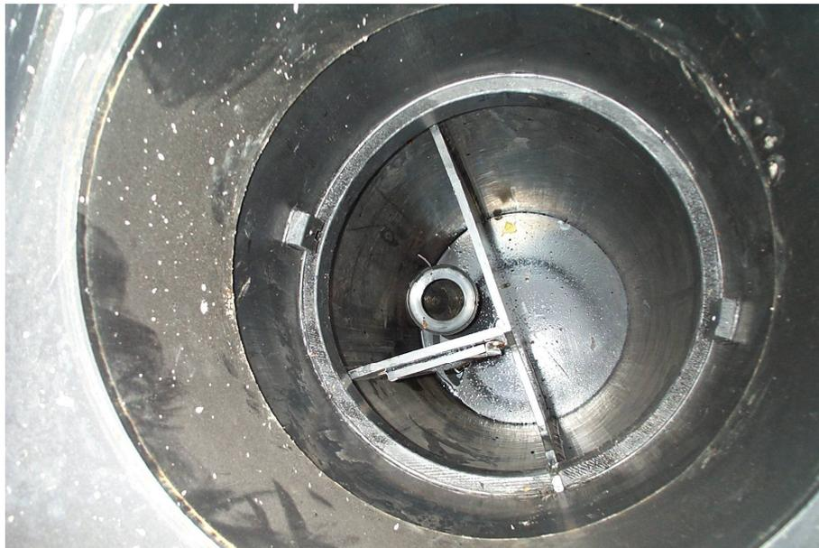
Abbildung 3: Blick in die unteren drei Kammern des Centrifloel-Systems (die Ventilkugel wurde hier entnommen)
