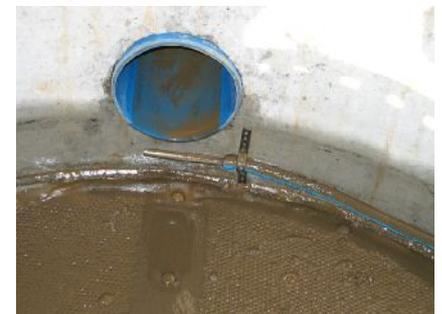
Abb. 57: Ablaufbeprobung oberhalb Filtersystem 1 und 2
