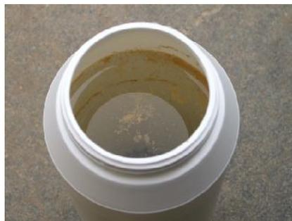
Abb. 56: Zulaufprobe mit Blütenstaub an der Oberfläche
