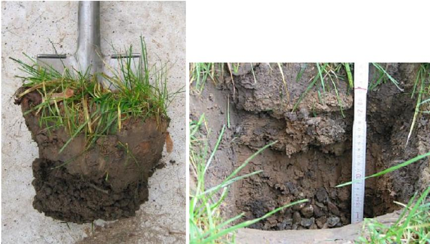
Abb. 20: Untersuchung des Bodens der Versickerungsmulde
