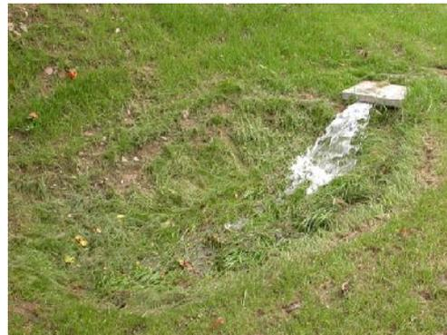
Abb. 19: Beschickung der Versuchsmulde durch eine Pumpe
