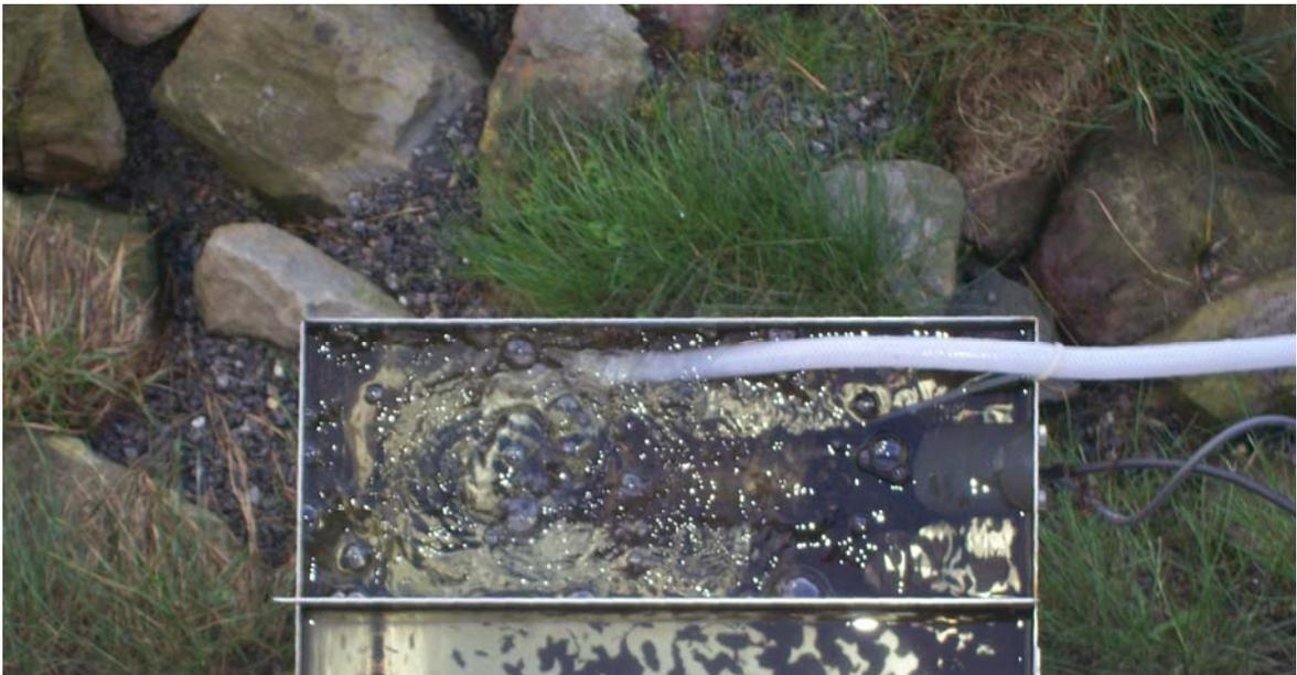
**Abbildung 6.2: Edelstahlbehälter für AN-ISE-Sonde**
