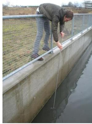
Abbildung 3.2: Sedimententnahme an einem RKB
