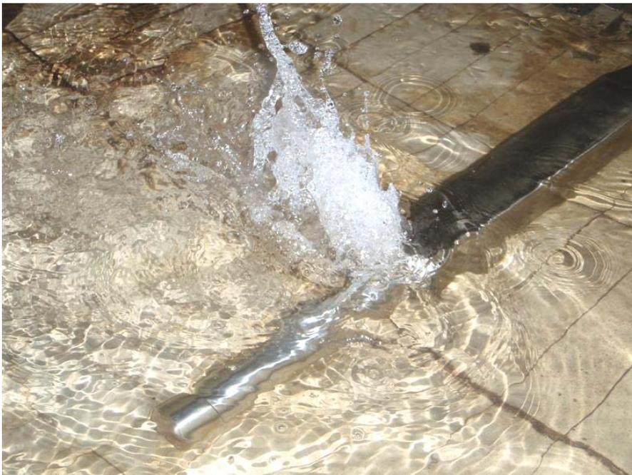
Bild 9 Im Sohlbereich des Briller Baches fixierte Photometersonde während der Druckluftspülung
