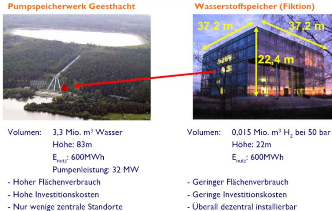
**Bild 3-12: Vergleich Pumpspeicherwerk und Wasserstoffspeicher nach [28]**
