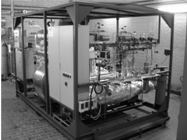
**Bild 5-12: Transportabler MCFC-Teststand auf der Kläranlage Wuppertal-Kohlfurth [108]**
