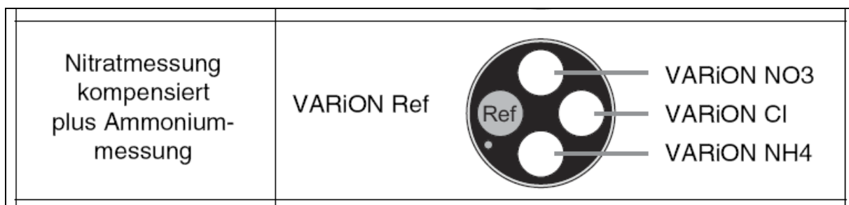
Bild 12.3 Konfiguration des VARiON-Sensors der 2. Studie (aus WTW [2005a])
