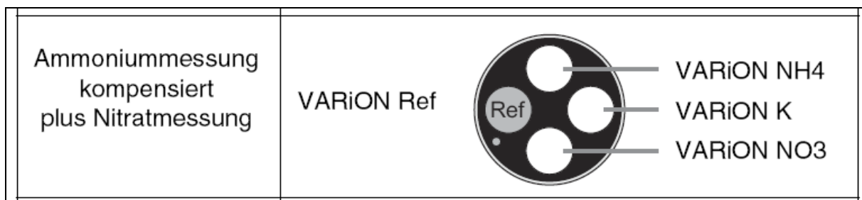
Bild 12.2 Konfiguration des VARiON-Sensors der 1. Studie (aus WTW [2005a])
