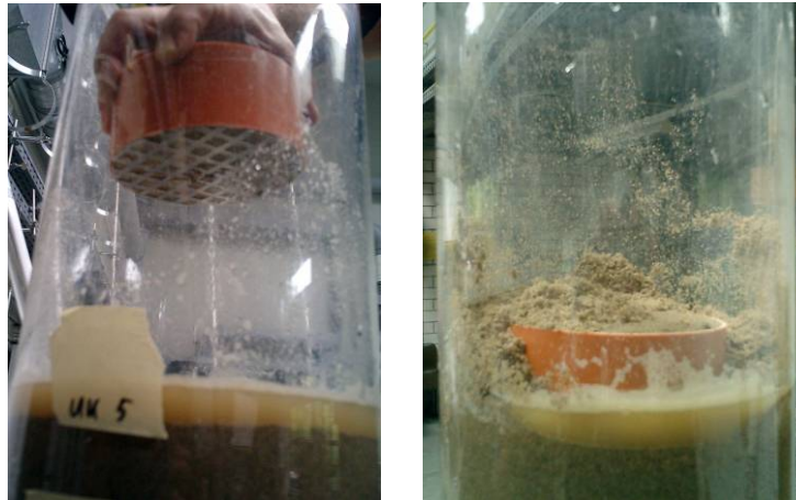
Bild 5.3: Einbau der Behälter zur Substratentnahme für die anschließenden Nutschenversuche am Standort TU KL
