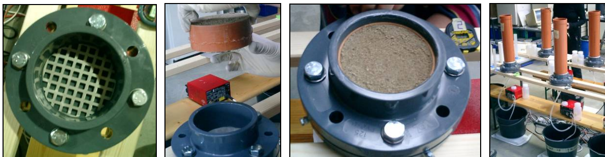
Nutsche leer von oben (links), Einbau Entnahmekörper (Mitte links), Nutsche gefüllt (Mitte rechts), Versuchsstand (rechts)
