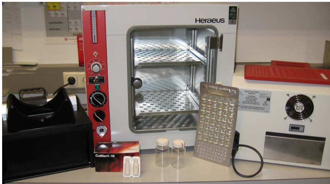
Bild 1: Laborgeräte und -materialien für das Colilert-18/Quanti-Tray-Verfahren
