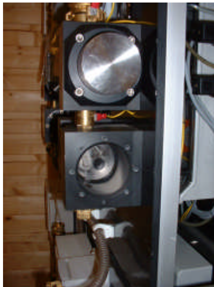
Abbildung 4-5: Blick in die Messkammer des Kanalsamplers an der Messstelle I
