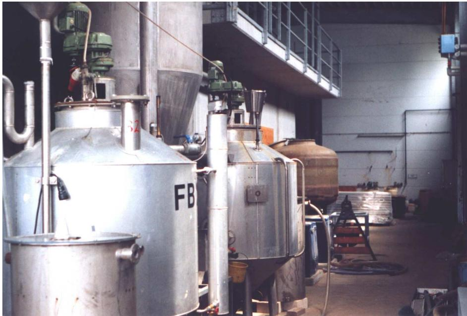
Abbildung 5: Versuchsanlage mit Faulbehältern zur Klärschlammfäulung (FB1, Bildmitte) und zur Co-Vergärung (FB2)
