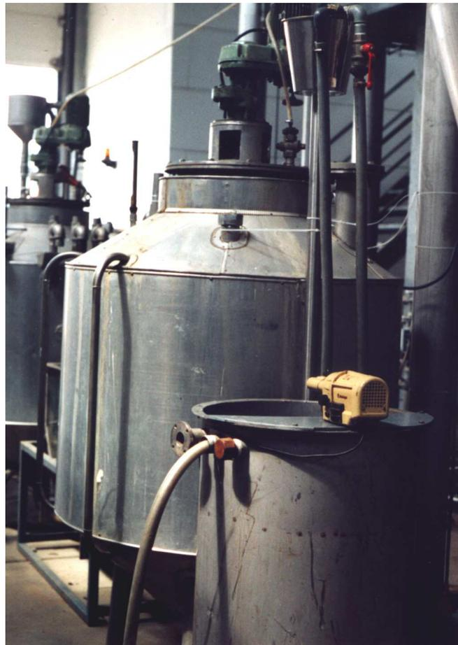
Abbildung 6: Vorlage- und Faulbehälter der Versuchsanlage
