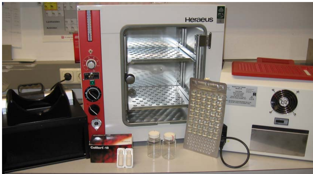
Bild 3: Laborgeräte und -materialien für das Colilert-18/Quanti-Tray-Verfahren
