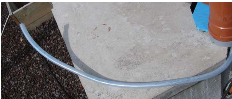
Bild 2: Beispiel eines Probenahmeschlauchs der Kleinkläranlagen mit Membranfiltration
