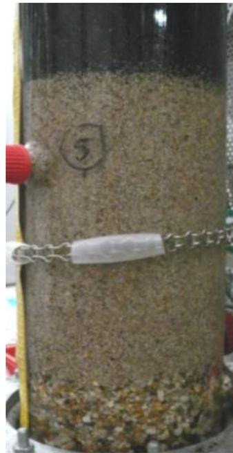
nach Wasserspülung oberhalb des Lockerungspunkts wieder hergestellter Schichtaufbau
