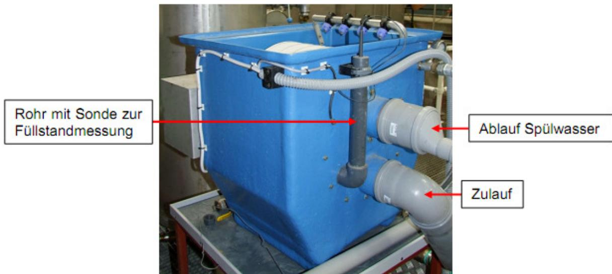
**Bild 6.5:** Seitenansicht der Mikrosiebanlage (ohne Deckel)
