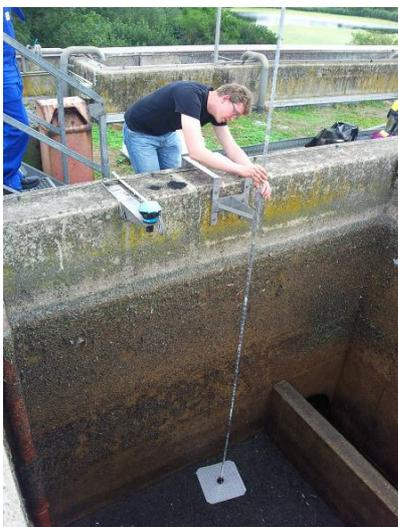
**Bild 4.17: Messung der Filterbetthöhe (hier mit abgelassenem Überstau)**
