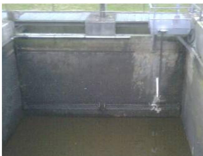
**Bild 5.5: Versuchsfilterzelle mit leerem Überstand und Rührwerk**
