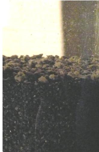
GAK-Oberfläche in Versuchssäule nach Luft- und anschließender Wasserspülung
