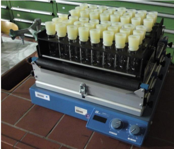
**Bild 3.6: Versuchsaufbau zur Ermittlung der Adsorptionsisothermen in Zentrifugengläsern auf einem Horizontalkreisschüttler**
