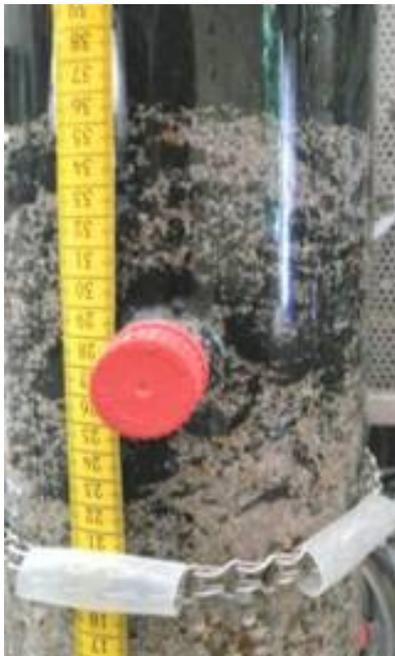
zerstörte Schichtung des Filteraufbaus durch Luftspülung
