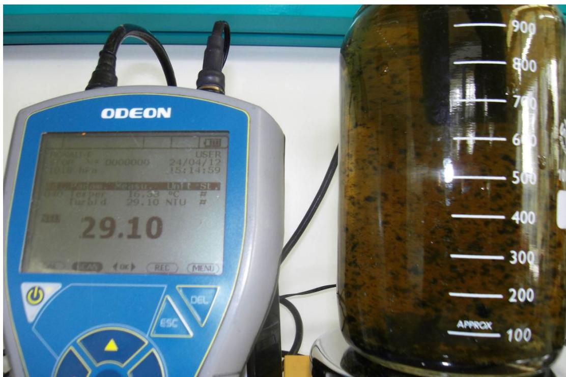
**Bild 6.18: Messstand zur Bestimmung der Absetzeigenschaft mittels Trübungsmessung**
