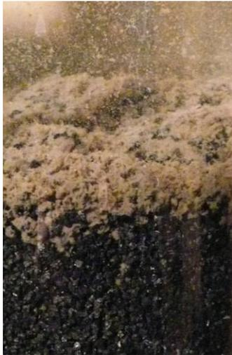
GAK-Oberfläche in Versuchssäule nach reiner Wasserspülung
