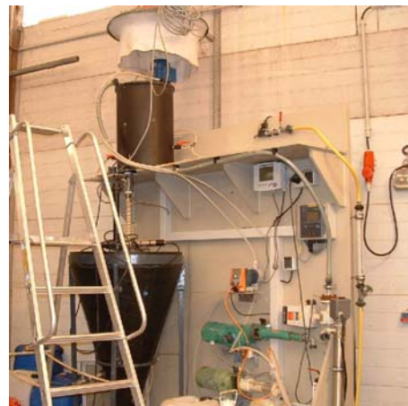
Abbildung 2.8: P-Fällung aus Urin
