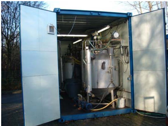
Abbildung 2.11: 2-straßige Faulungs- anlage
