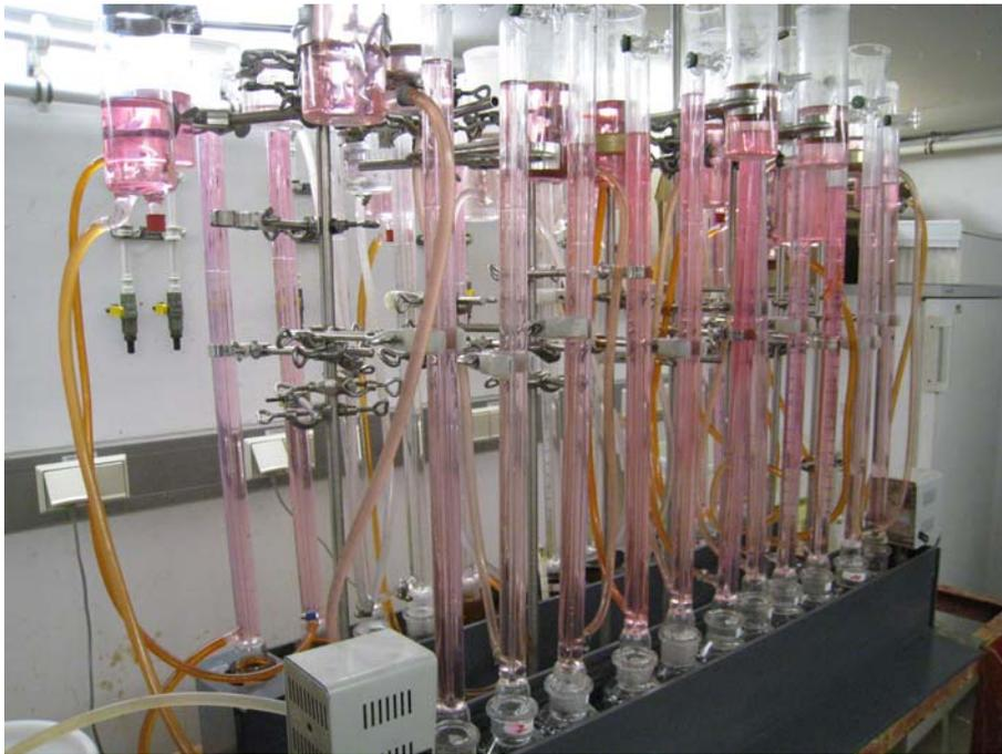
**Bild 3-3: Versuchsaufbau der Faulversuche**
