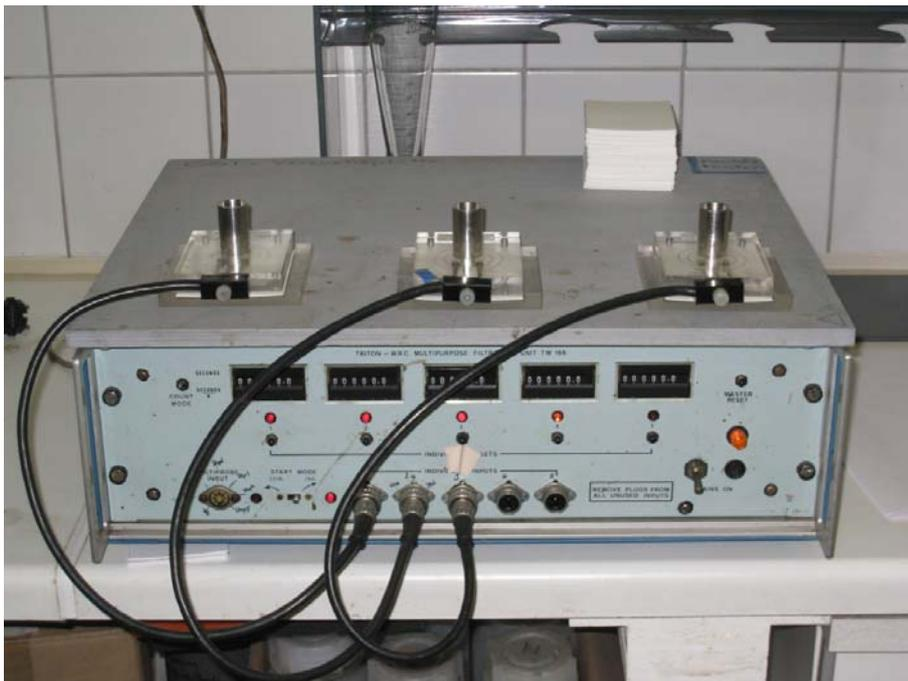
**Bild 3-5: CST-Gerät „Triton W.R.C Multipurpose Filtration Unit TW 166“**
