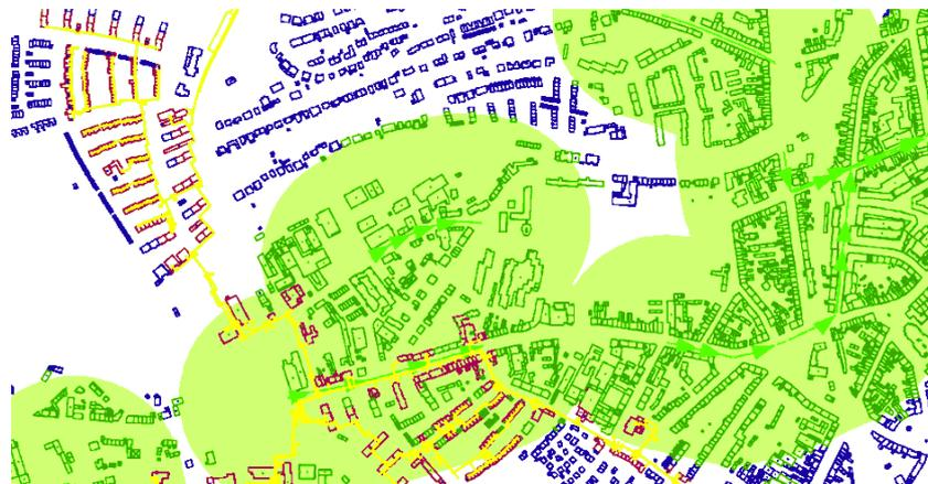
**Bild 4-3:** Karte mit Nutzungsbereichen zur Abwasserwärmeversorgung. Fernwärmenetz (gelb), Gebäudebestand der nicht mit Fernwärme versorgt wird (blau), geeignete Haltungen (grüne Pfeile) für den Einbau von Wärmetauscher sowie geeigneter Nutzungsradius 200 m (hellgrün)
