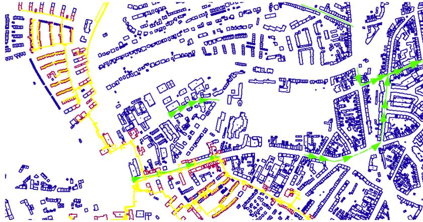
**Bild 4.2:** Karte mit Gebäudebestand ohne (blau) und mit (rot) Anbindung an das bestehende Fernwärmenetz. Identifikation von geeigneten Standorten für den Einbau von Plattenwärmetauscher (grün) anhand bestehender Abnehmerpotenziale und Nutzungsstrukturen
