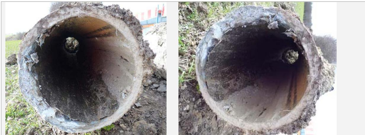
Abb. 22: Gequollenes Asbestzementrohr einer Abwasserdruckleitung [45]
