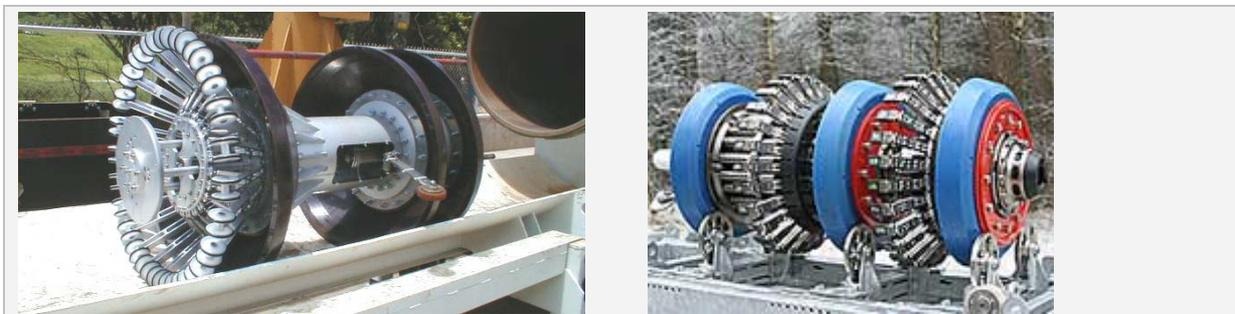
Abb. 37: Beispiele von Molchen zur Geometriemessung:
