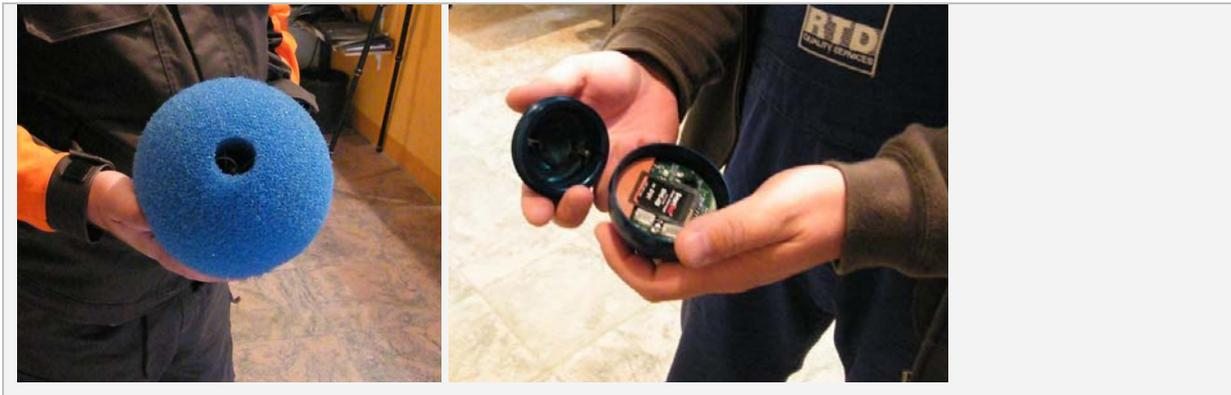
Abb. 41: Schaumstoffhülle (li) und Technik-Kern (re) des SmartBall®
