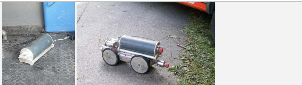
*Abb. 98: Radarantenne (li) und Fahrwagen mit Radarantenne (re)*
