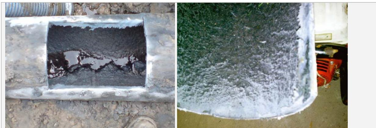
Abb. 23: Ausschnitt eines korrodierten Asbestzementrohres einer Abwasserdruckleitung [39]
