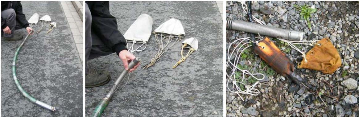
Abb. 26: Schleppkamera - Axialkamera mit unterschiedlichen Saugschirmen
