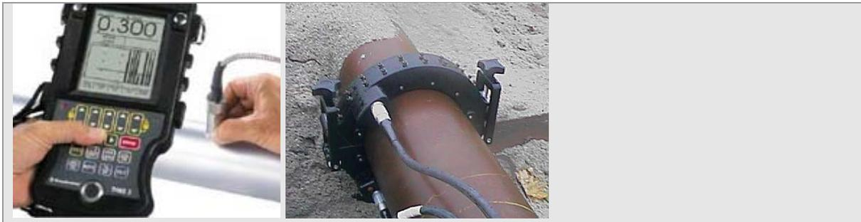
Abb. 46: „DMS 2“ Ultraschall-Wanddicken-Messgerät der GE Inspection Technologies GmbH (li) [102], Wavemaker™ der Applus RTD Group (re) [101]
