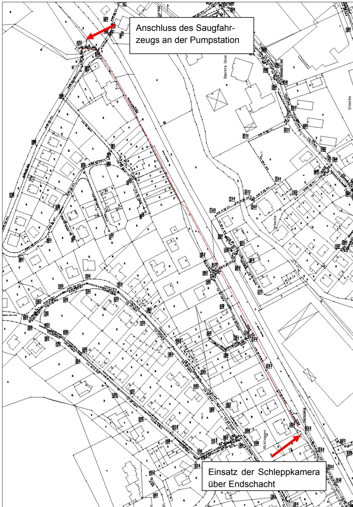
Abb. 62: Lageplan Druckleitung PE-HD, Innendurchmesser rund 100 mm, Länge 510 m, Hemer
