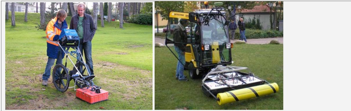
Abb. 48: Beispiele einer einzelnen Radarantenne der DMT GmbH (li) und Bodenradar „Detectino“ mit fünf kombinierten Radarantennen sowie weiterer Messtechnik (re)
