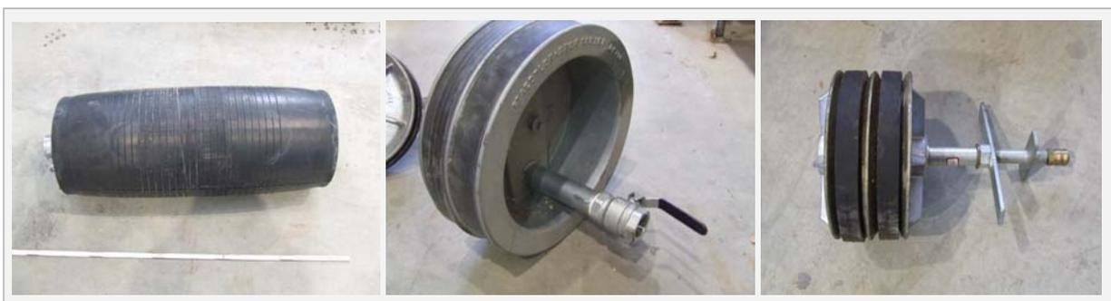
Abb. 50: Beispiele einer Absperrblase (li) und Beispiele zu Rohrverschlüssen (mi, re)
