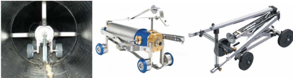
Abb. 40: Messsonde im Rohr (li), Messsonde für DN 150-400 (mi) und für DN 450-800 (re) [92]
