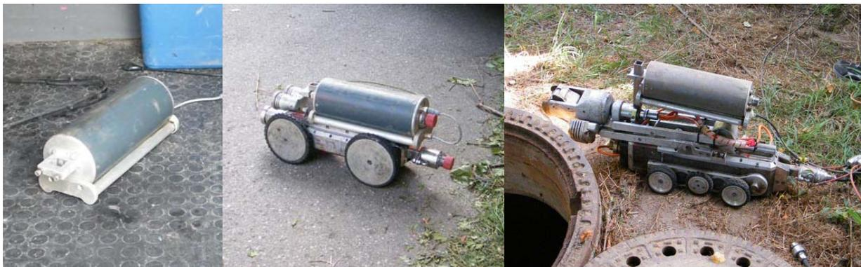
Abb. 27: Radarantenne (li) und unterschiedliche Fahrwagen mit montierter Antenne (mi, re)
