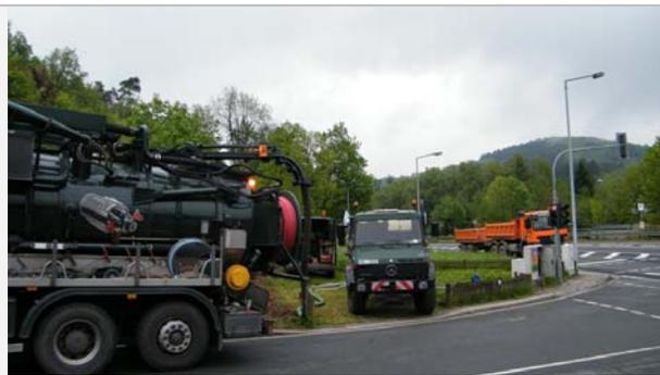
Abb. 59: Saugfahrzeug an der Pumpstation (li)
