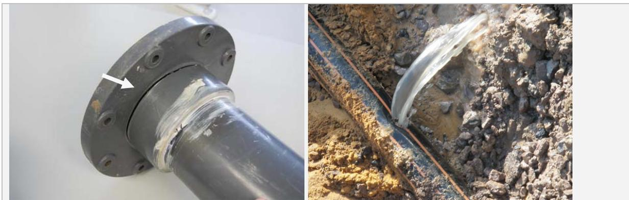
Abb. 18: Rissbildung in einer Flanschverbindung eines PVC-Abwasserdruckrohres in der Pumpstation (li) [39]
