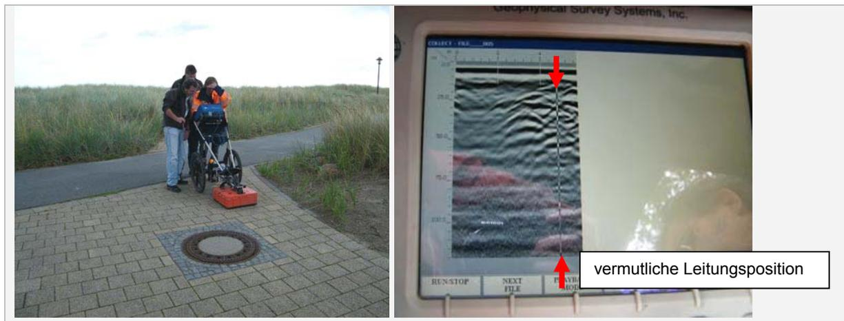
Abb. 105: Messstelle 3-1: Vermutliche Rohrposition (li) und zugehöriges Radargramm (re)
