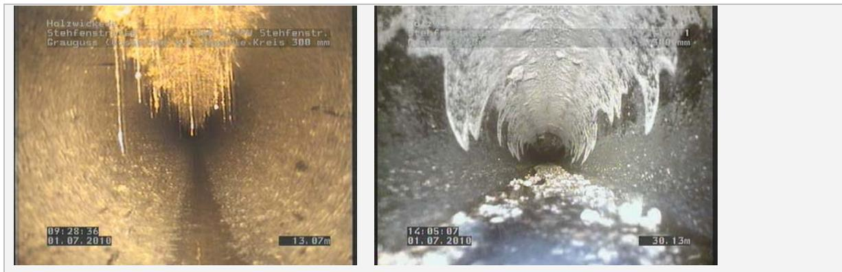
Abb. 80: Fettablagerungen vor HD-Spülung (li), Fettablagerungen nach erstem Spüldurchgang (re)
