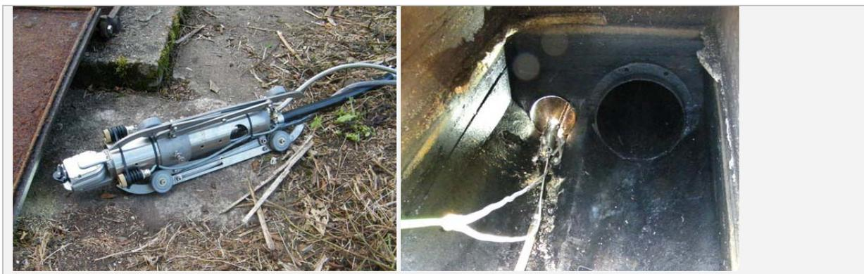
Abb. 85: Dreh-/Schwenkkopfkamera mit Führungsschlitten (li) und Einsatz der Kamera in das Dükerende am Unterhaupt (re)
