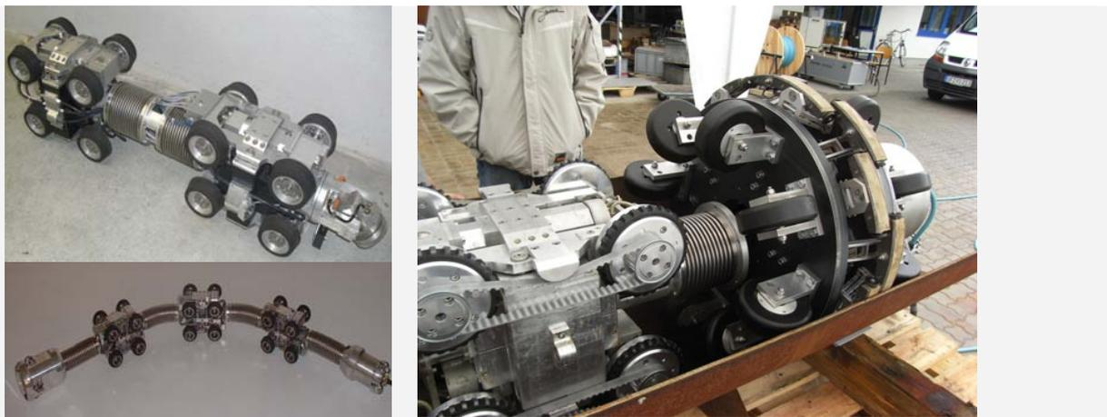
Abb. 30: Beispiele der Inspektionsroboter der Fa. Inspector Systems: Roboter mit Kameramodul (li) Roboter mit Wirbelstromprüftechnik (re) [68]
