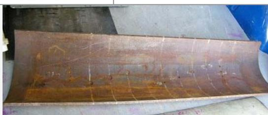
Abb. 117: Beispiel einer Referenz-Rohrhalbschale zur Kalibrierung des SLOFEC (hier Stahl)
