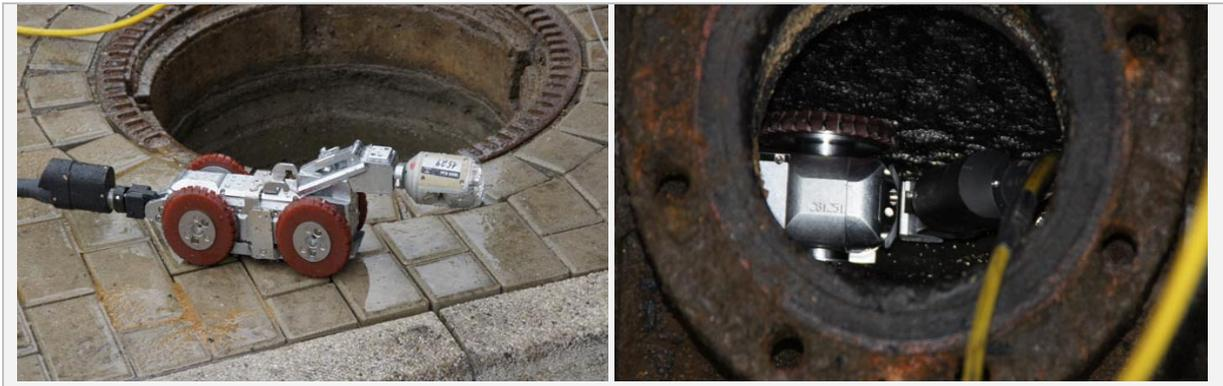
Abb. 82: Eingesetzte Fahrwagenkamera (li) und durch Revisionsöffnung eingesetzte Kamera (re)
