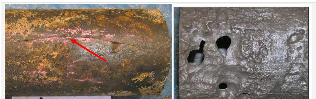
Abb. 14: Längsriss (li) sowie Mulden- und Lochkorrosion (re) in Trinkwasser-Graugussrohren [34]
