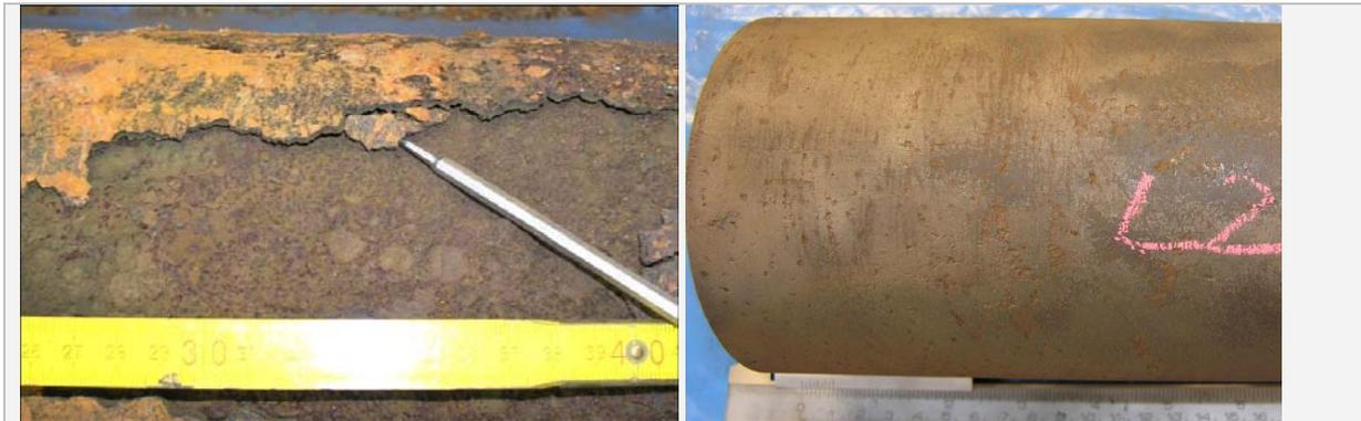
Abb. 15: Graphitierte Schicht eines Trinkwasser-Graugussrohres (li) [34] und Narbenkorrosion mit beginnender Lochkorrosion eines Trinkwasser-Stahlrohres (re) [34]
