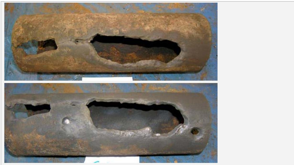
Abb. 16: Graphitiertes Trinkwasser-Graugussrohr vor dem Sandstrahlen (oben) und danach (unten) [34]
