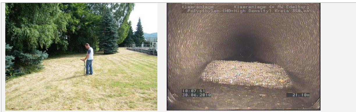
Abb. 71: Ortung der Kamera (li); Sandablagerungen in der Druckleitung (re)
