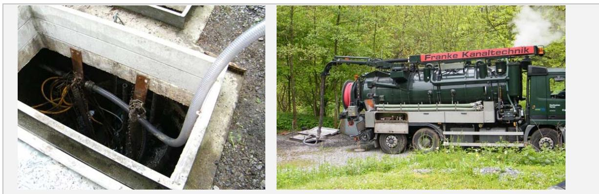
Abb. 65: Anschluss Saugfahrzeug am Pumpwerk (li) und Saugfahrzeug (re)
