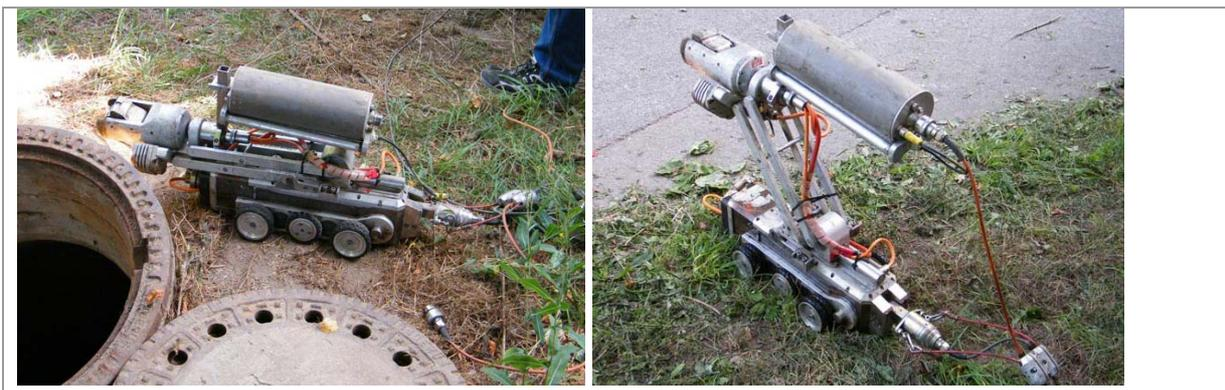
Abb. 100: Kamera mit Radarantenne in unterschiedlichen Positionen
