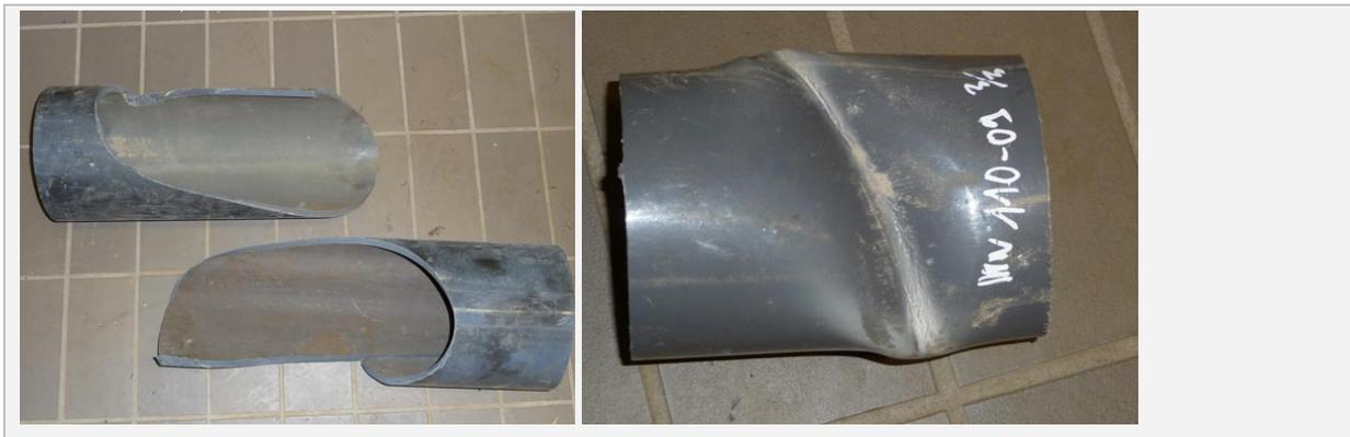
Abb. 21: Spiralbruch eines PVC-Druckrohres aufgrund hohen Innendruckes (li) und übermäßige Verformung durch punktuelle Belastung eines PVC-Druckrohres (re) [41]
