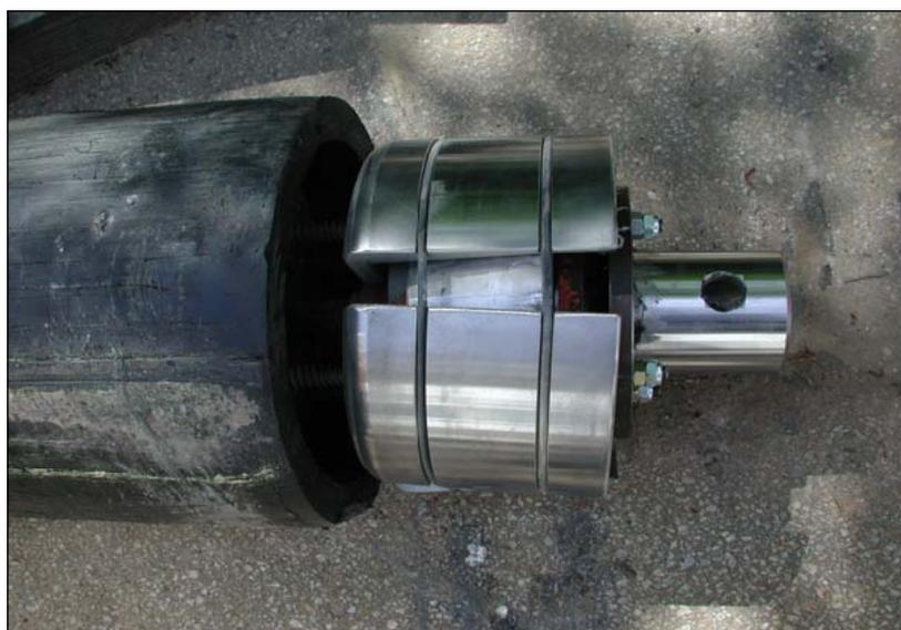
Bild 4.9: Innenverdichter bei der Einbau- und Funktionskontrolle
