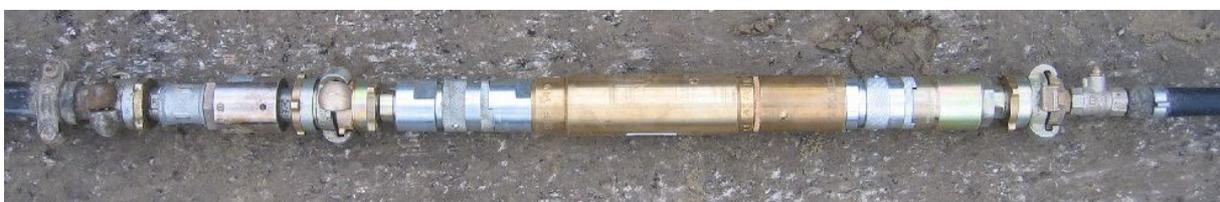
Bild 7.20: Drehwirbel (links) und Schockventil (rechts) am Druckluftschlauch des Innenverdichters
