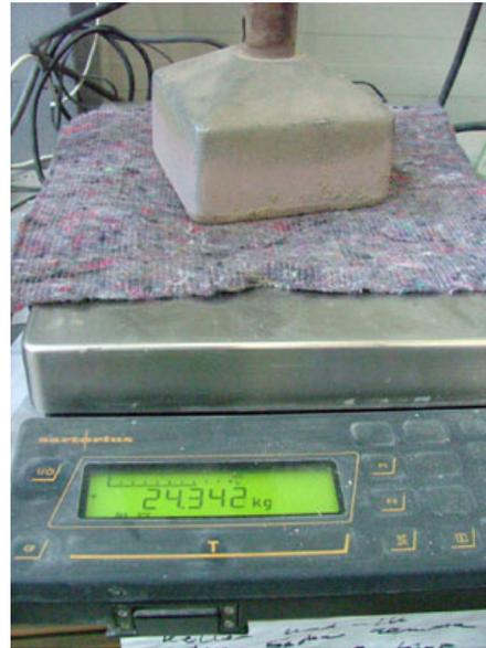
Bild 6.11: Gewicht des leichten Verdichtungsgerätes
