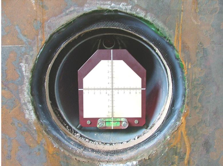
Bild 6.13: Zieltafel an der ersten Position eines Rohrstranges aus PE (Position 1). Nach jedem Wechsel der Messposition wurde die Zieltafel unter Benutzung der Libelle horizontalisiert. Die Skala der Zieltafel wurde mit Hilfe des Nivelliergerätes zur Ermittlung von Lageänderungen des Rohrstrangs an jedem Messpunkt abgelesen (Skalenteilung 1 [mm])
