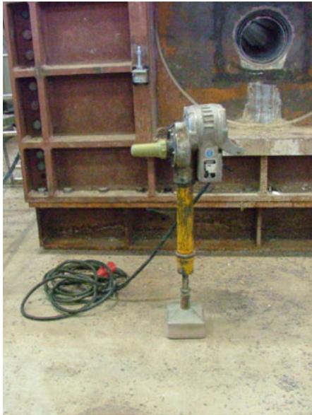
Bild 6.10: Leichtes Verdichtungsgerät
