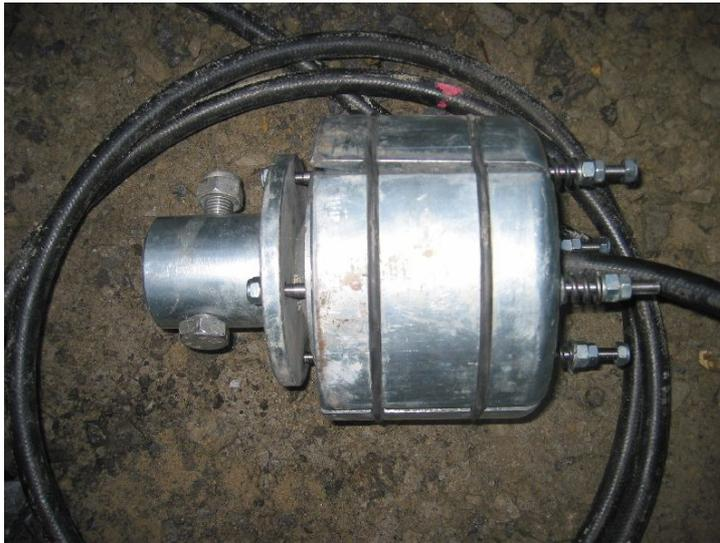
Bild 7.17: Innenverdichter mit großem Innenkern und großem Backensatz
