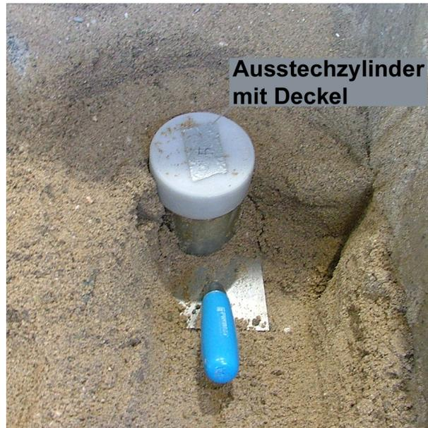
Bild 6.28: Entnahme von ungestörten Bodenproben mittels Ausstechzylinder zur Bestimmung der Dichte nach DIN 18125-2 [45]. Der Ausstechzylinder wird in den Boden eingedrückt, verschlossen, und anschließend ohne Veränderungen mithilfe einer Maurerkelle entnommen
