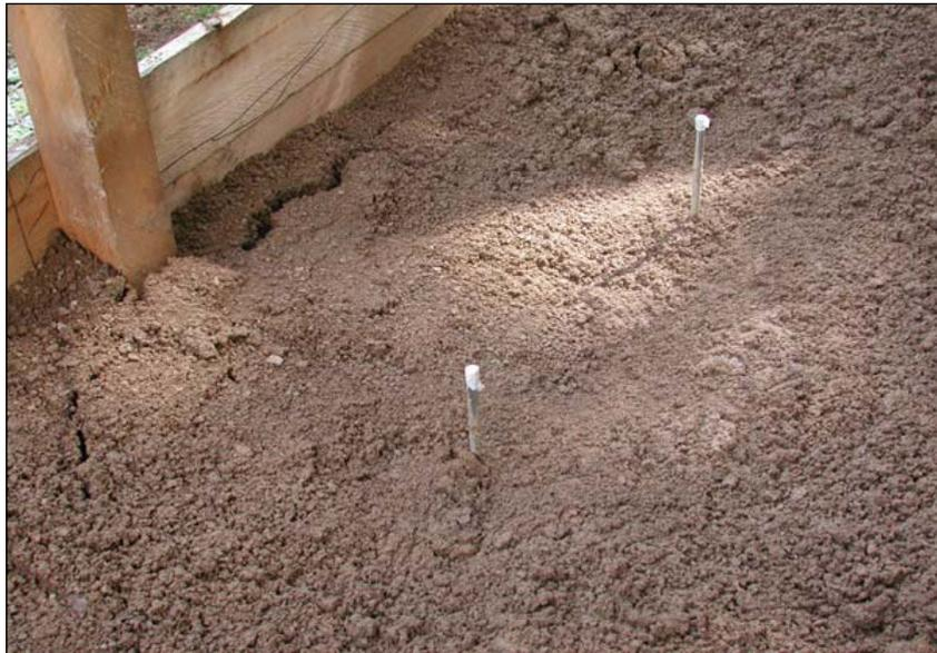
Bild 4.15: Risse im Randbereich der Überschüttung nach dem Verdichtungsvorgang
