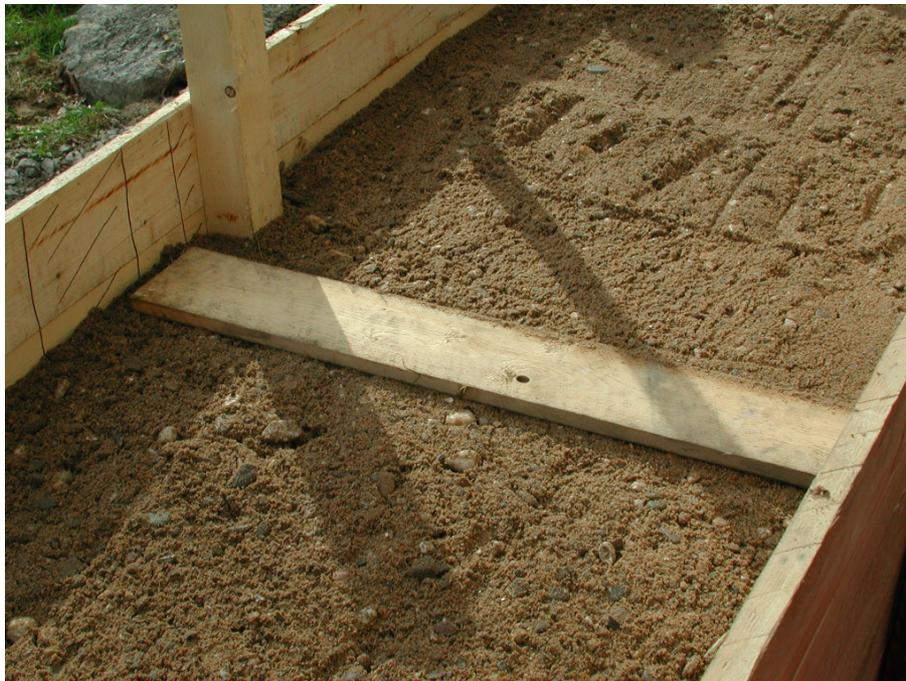
Bild 4.6: Test 3: Abziehen der Oberfläche der Überschüttung mit einem Brett
