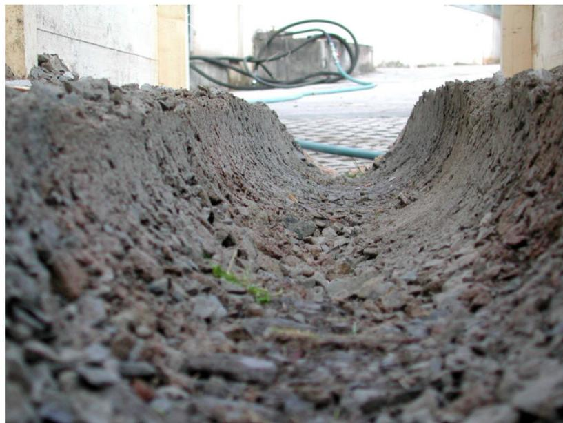
Bild 4.5: Test 2: Verfüll- und Verdichtungszustand im Bereich der Rohrzwickele
