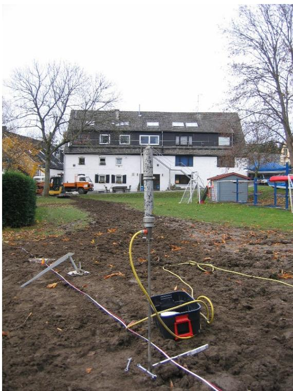
Bild 7.10: Einsatz der leichten Rammsonde „DPL-5“
