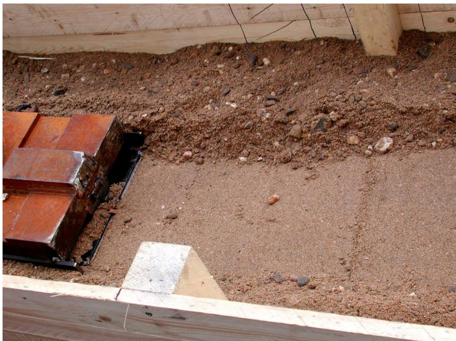
Bild 4.7: Test 4: Einsatz einer Ballastplatte auf der Oberfläche der Überschüttung parallel zum Innenverdichter
