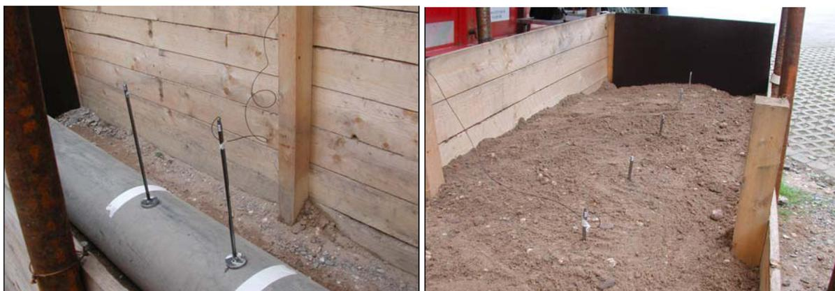
Bild 4.13: Beschleunigungsaufnehmer mit Messsonden mit und ohne Bodenverfüllung
