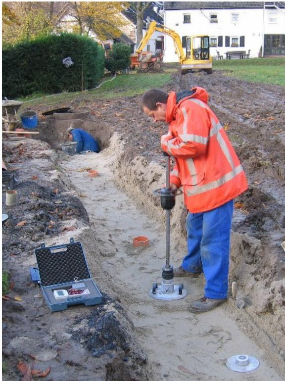
Bild 7.9: Durchführung des dynamischen Plattendruckversuches
