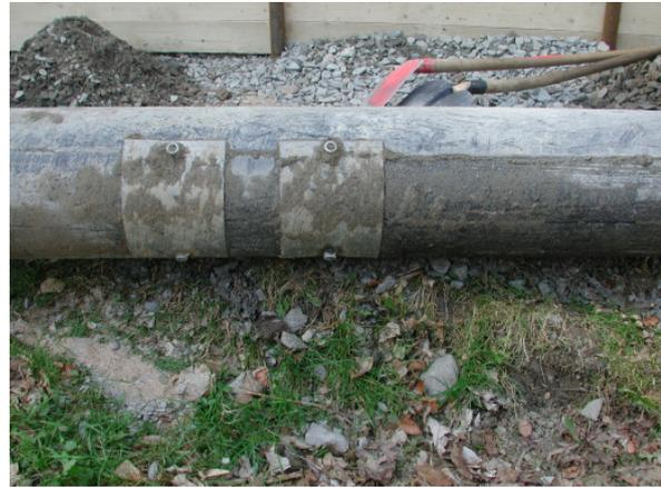
Bild 4.3: Rohr im ausgebauten Zustand nach dem Verdichtungsverfahren
