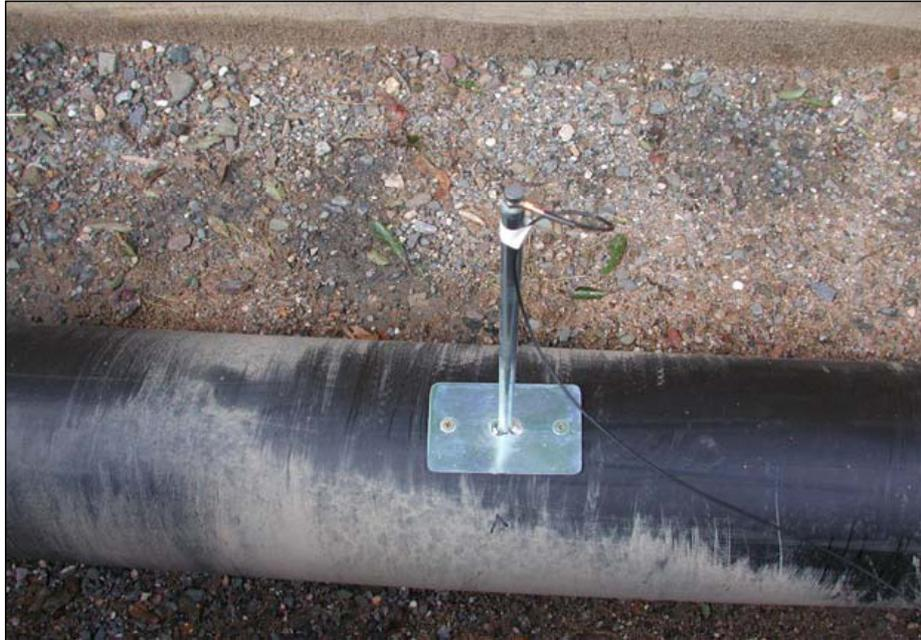
Bild 4.12: Kraftschlüssige Befestigung der Messsonde auf dem Rohr
