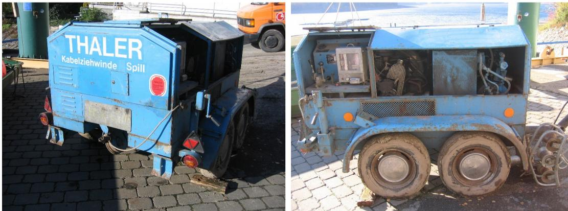
Bild 7.5: Kabelziehwinde zum Durchziehen des Innenverdichters
