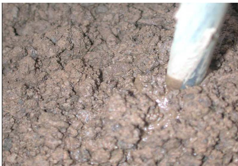
Bild 4.16: Wasseransammlung nach dem Verdichtungsvorgang auf der Schüttung
