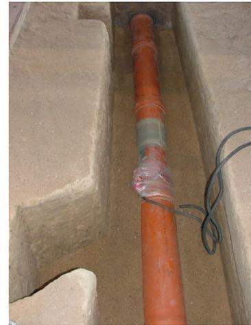
Bild 6.8:PVC-Rohr mit vier Muffenspalten unterschiedlicher Weite
