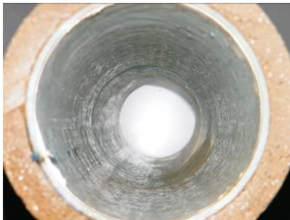
Steinzeug DN 150, Scheitelriss
