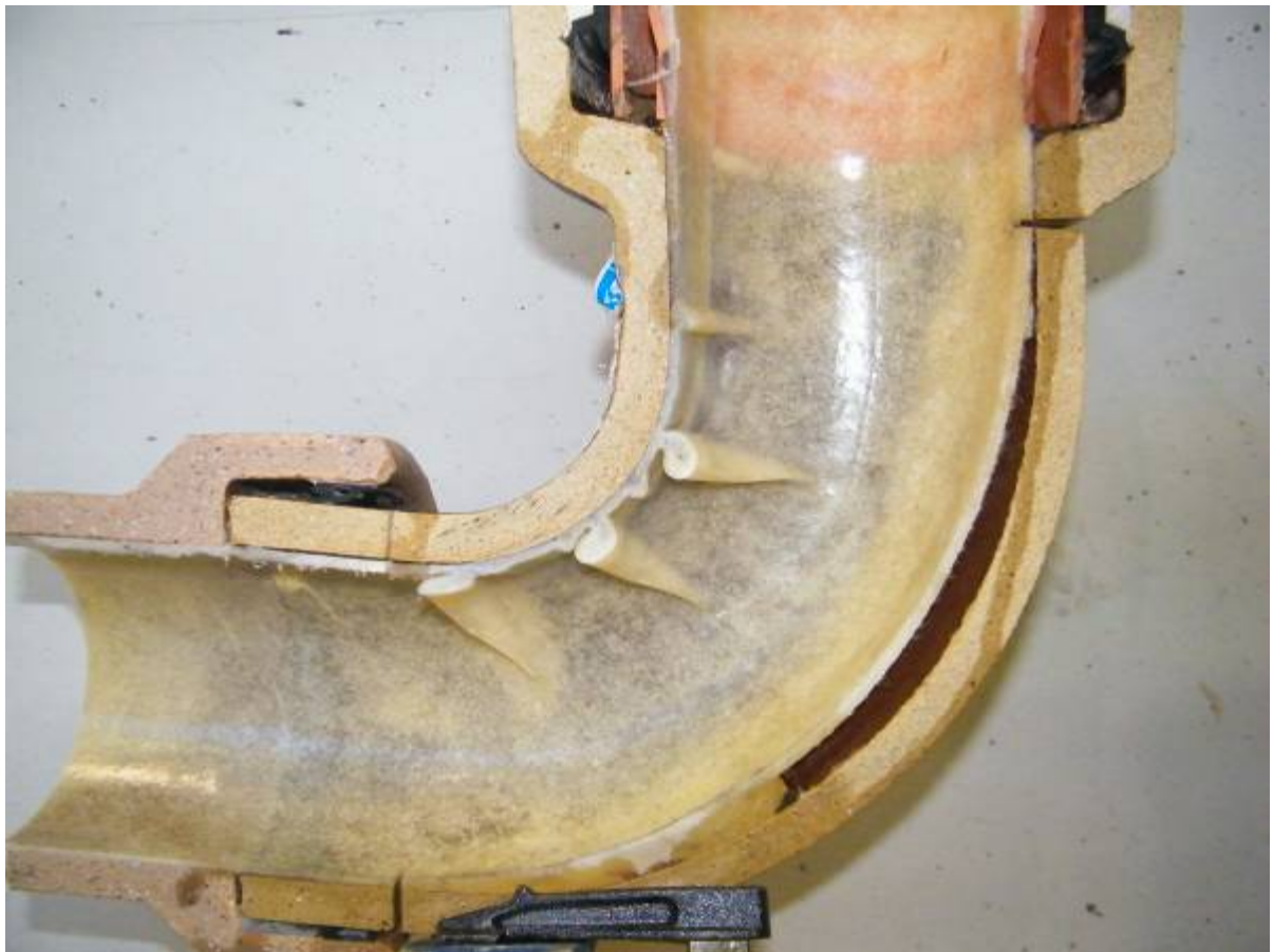
Steinzeug-Bogen 90°, DN 125, vertikal angeordnet
