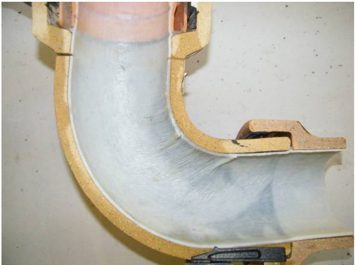
Steinzeug-Bogen 90°, DN 125, vertikal angeordnet
