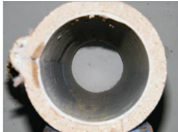
Steinzeug DN 125, Kämpferriss
