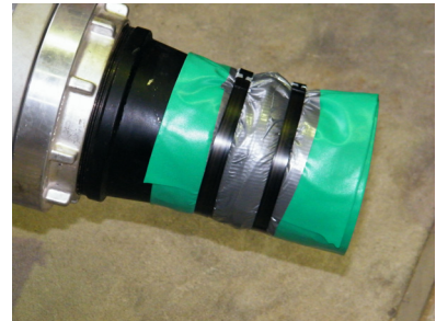
l) Kalibrierschlauch am Inversionsstutzen
