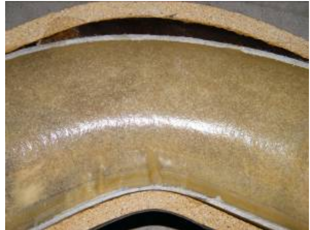
Steinzeug-Bogen 45°, DN 125, Sohlbereich vertikal angeordnet
