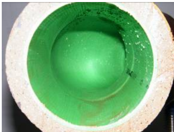
Steinzeug-Bogen 30°, DN 150, horizontal angeordnet, in Fließrichtung
