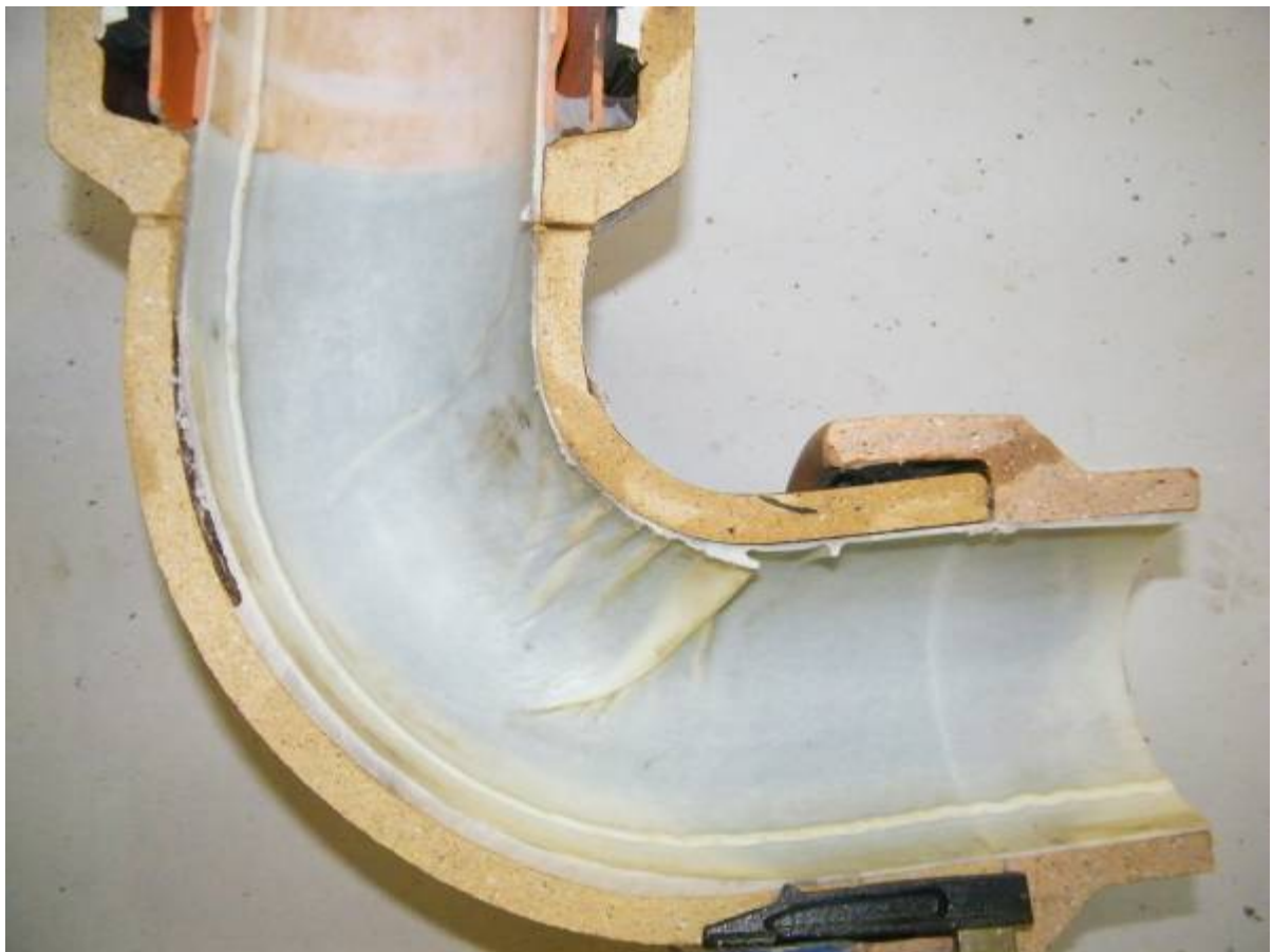
Steinzeug-Bogen 90°, DN 125, vertikal angeordnet
