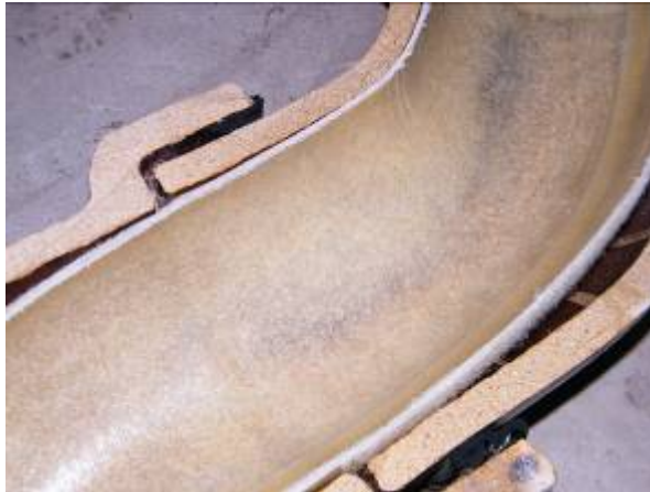
Steinzeug-Bogen 45°, DN 125, Sohlbereich vertikal angeordnet
