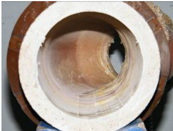
Übergang PVC-KG DN 125 auf Steinzeug DN 125
