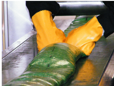
j) und k) Imprägnieren des Liners
