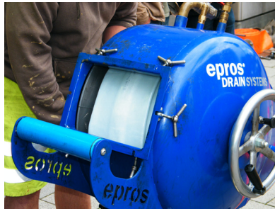
h) Inversionstrummel mit aufgewickeltem Liner
