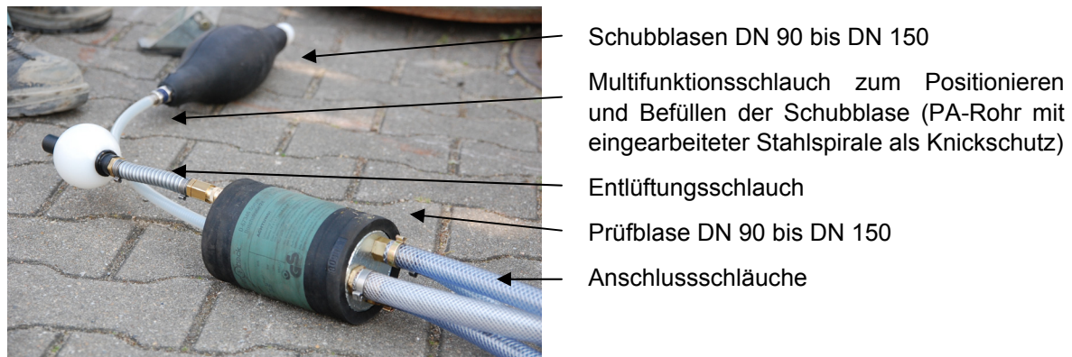
Abbildung 43: Prüfgerät für Hausanschlüsse der städtler + beck GmbH, Speyer
