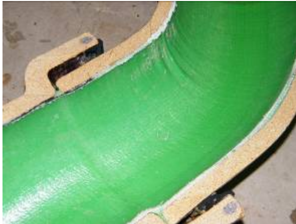
Steinzeug-Bogen 45°, DN 125, Sohlbereich vertikal angeordnet
