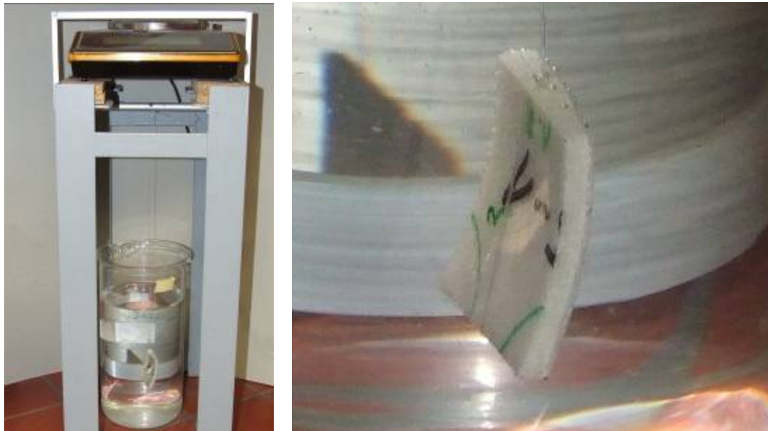
Abbildung 65: Versuchsaufbau zur Bestimmung der Dichte in Anlehnung an [40], eingetauchter Probekörper (rechts)
