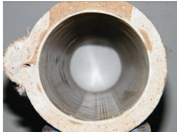
Steinzeug DN 125, Kämpferriss
