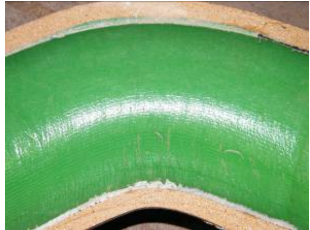
Steinzeug-Bogen 45°, DN 125, Sohlbereich vertikal angeordnet
