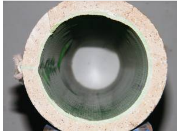
Steinzeug DN 125, Kämpferriss
