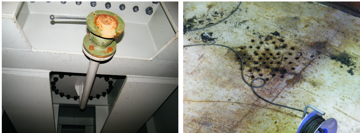
Abbildung 59: Wasserzulauf an der Unterseite des IKT Großversuchsstandes (links), Auslassöffnungen in der Bodenplatte (rechts)
