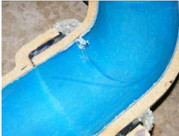
Steinzeug-Bogen 45°, DN 125, Sohlbereich vertikal angeordnet
