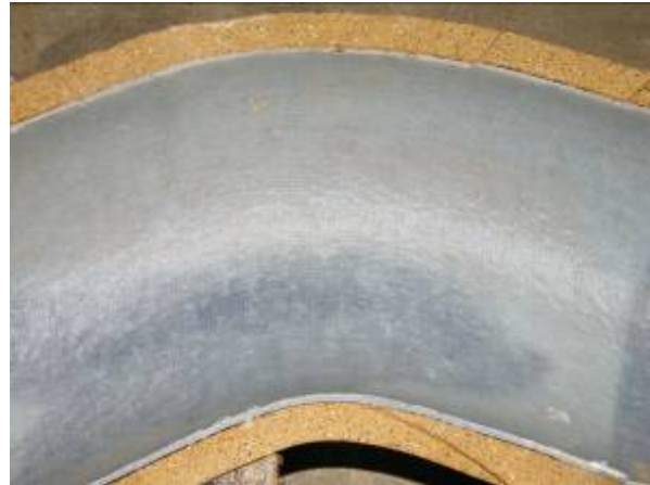
Steinzeug-Bogen 45°, DN 125, Sohlbereich vertikal angeordnet
