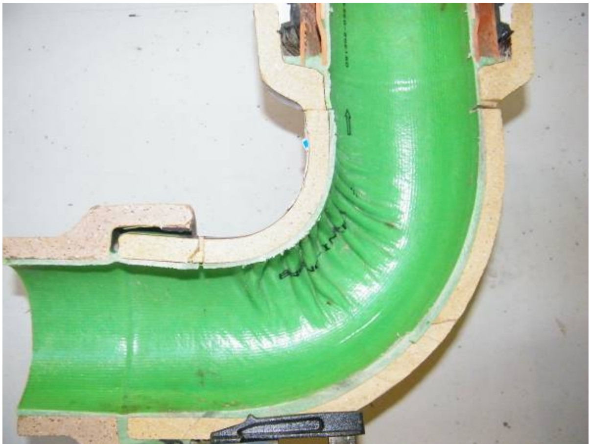
Steinzeug-Bogen 90°, DN 125, vertikal angeordnet
