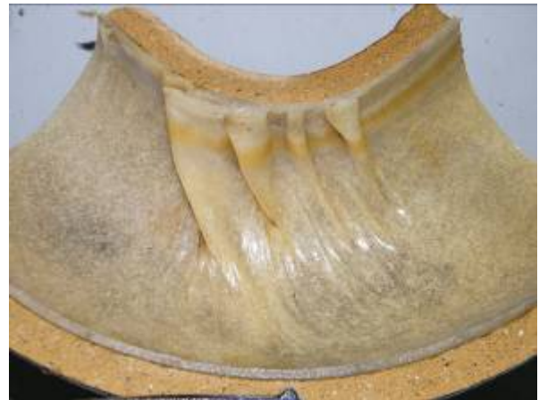
Steinzeug-Bogen 90°, DN 125, vertikal angeordnet
