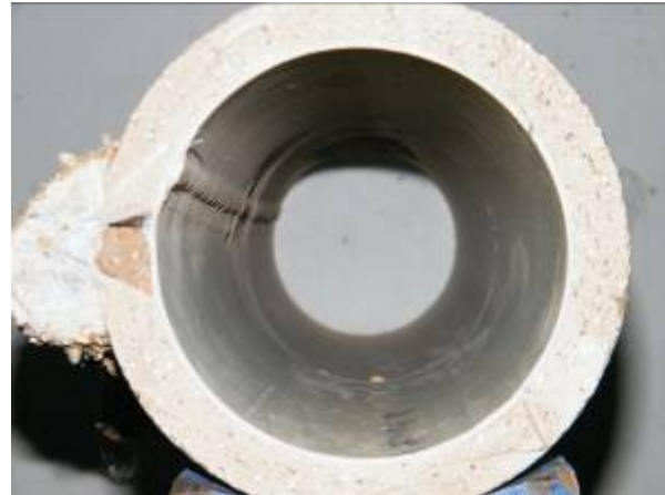
Steinzeug DN 125, Kämpferriss
