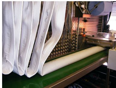
h) und i) Imprägnieren des Liners
