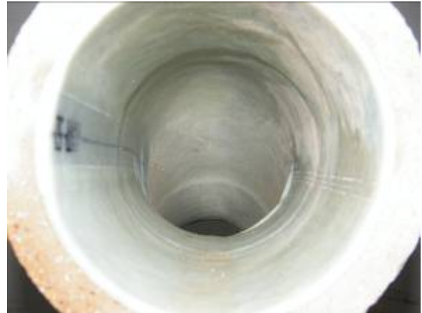
Steinzeug-Bogen 30°, DN 150, vertikal angeordnet, in Fließrichtung
