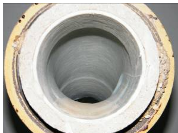
Steinzeug-Bogen 30°, DN 150, vertikal angeordnet, in Fließrichtung
