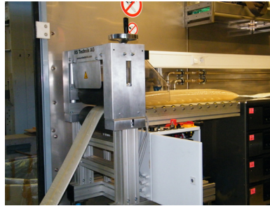
h) und i) Imprägnieren des Liners
