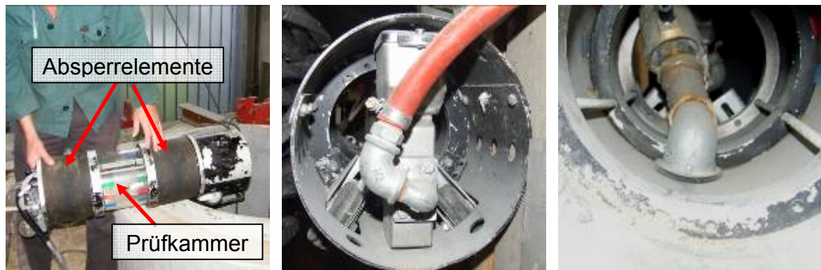
Abbildung 81: Durchflussmessgerät (links); Detailansicht des eingebauten MID (mitig); Auslass aus der Prüfkammer (rechts)
