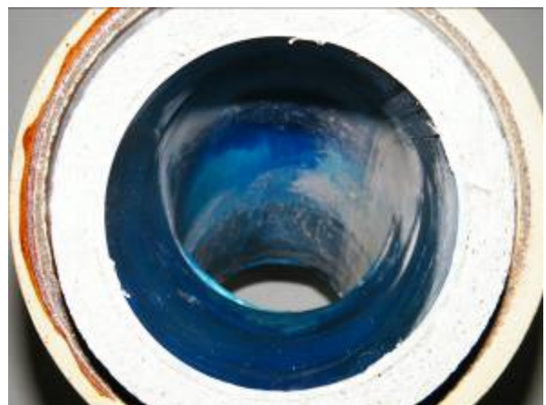
Steinzeug-Bogen 30°, DN 150, vertikal angeordnet, in Fließrichtung
