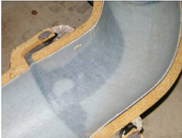
Steinzeug-Bogen 45°, DN 125, Sohlbereich vertikal angeordnet
