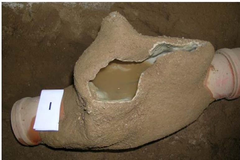
Abbildung 5-12: Abdichtungskörper einer Bentonit-Zementsuspension mit Hohlraum
