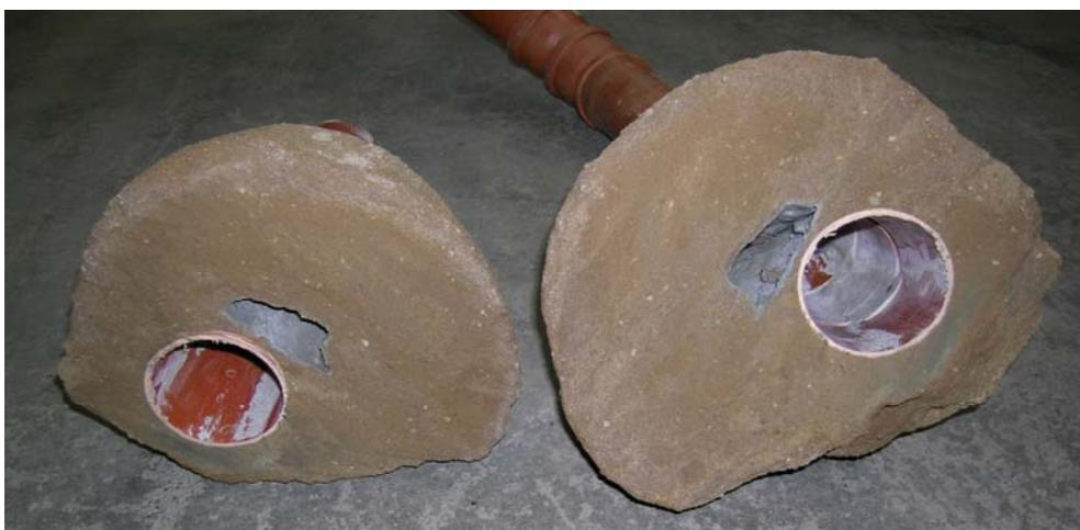
Abbildung 5-21: Abdichtungskörper um die Schadstelle 1
