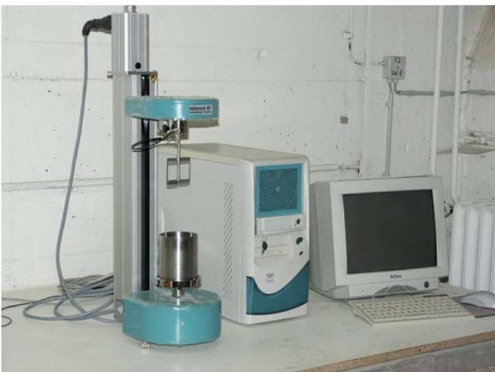
Abbildung 4-4: Rotationsviskosimeter Viskomat NT
