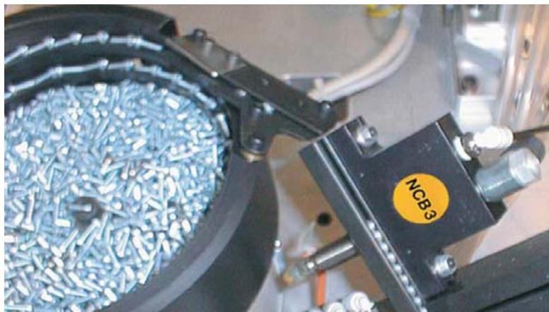
Abbildung 3-4: Druckluft-Kugelvibrator Typ NCB
