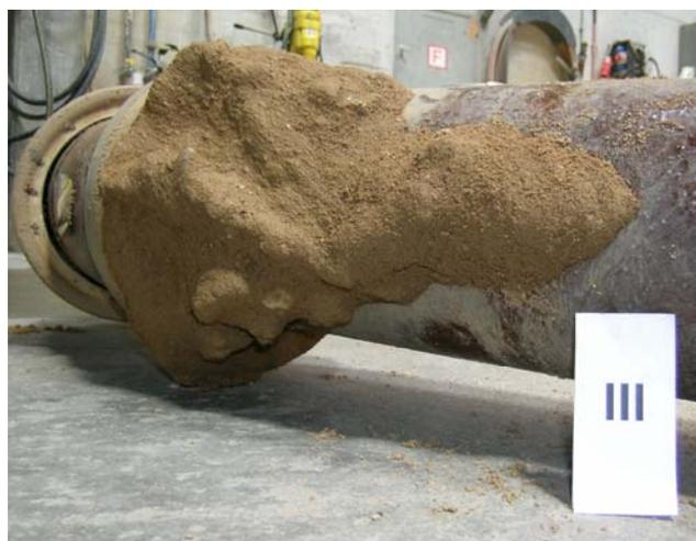
Abbildung 5-8: Injektionskörper bei einer Steinzeugmuffenverbindung
