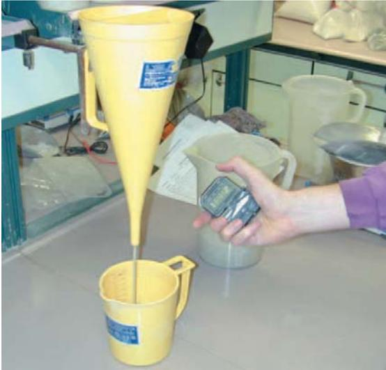
Abbildung 4-3: Marshtrichter-Versuch
