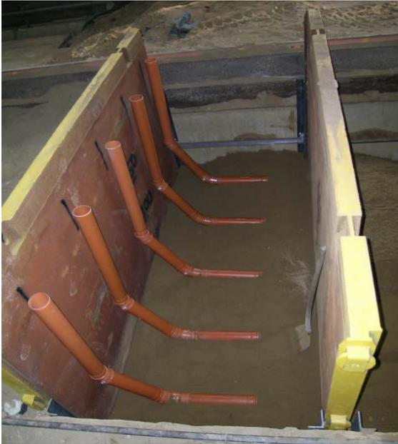
Abbildung 5-2: Einbau der Rohrleitungsabschnitte
