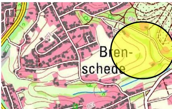
Abbildung 4-2: Abgleich der Höhenlinien zur Bestimmung der Gefällesituation (<http://www.geoserver.nrw.de/gbdaten.html>)
