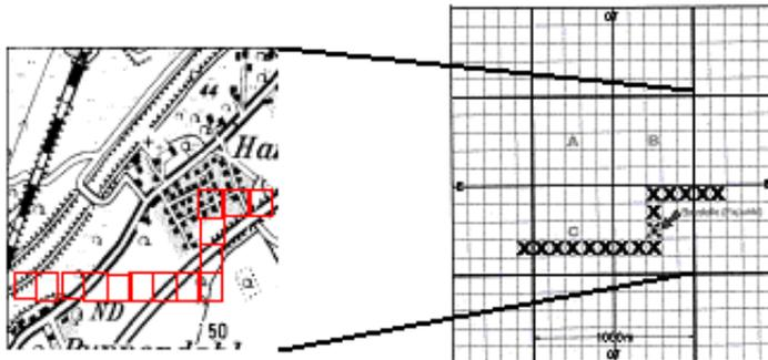
**Abbildung 6—2: Einschränkungen bei der Standortsuche durch unterirdische Kabel- und Leitungstrassen (www.aliz.de, 2011)**
