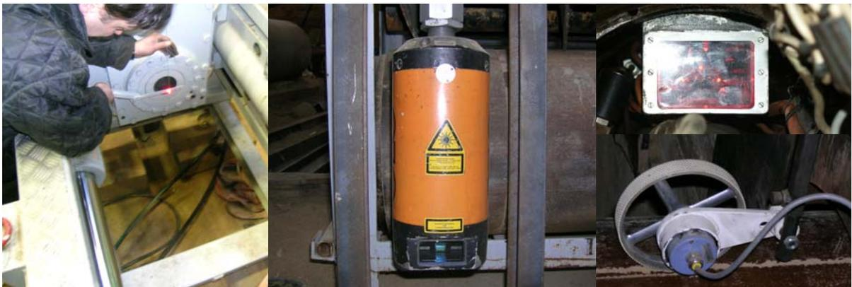
Bild 5.5: Vermessung im Vortriebsversuch am ibb - Institut für Baumaschinen und Baubetrieb: Laserkontrolle (links), Richtlaser (Mitte), aktive Zieltafel und Messrad (rechts)
