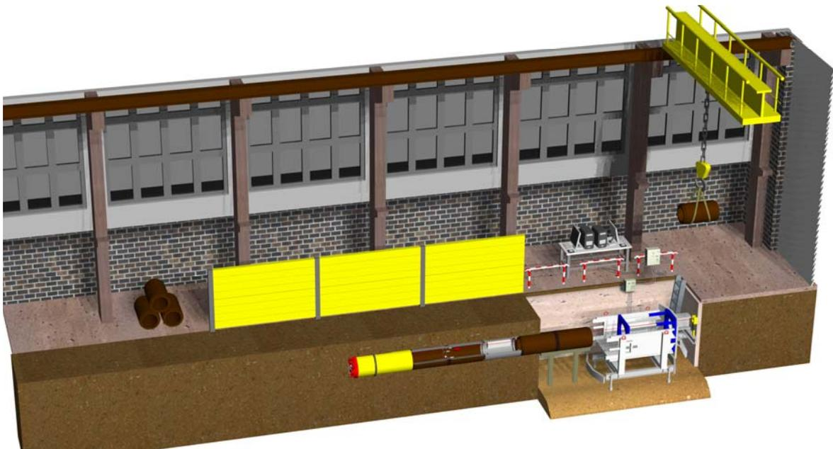
Bild 5.1: Vortriebsstrecke, Versuchsaufbau
