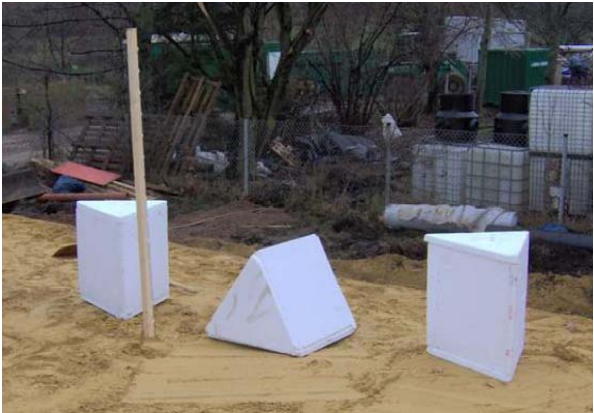
Bild 5.17: In das Versuchsfeld eingebaute Störkörper
