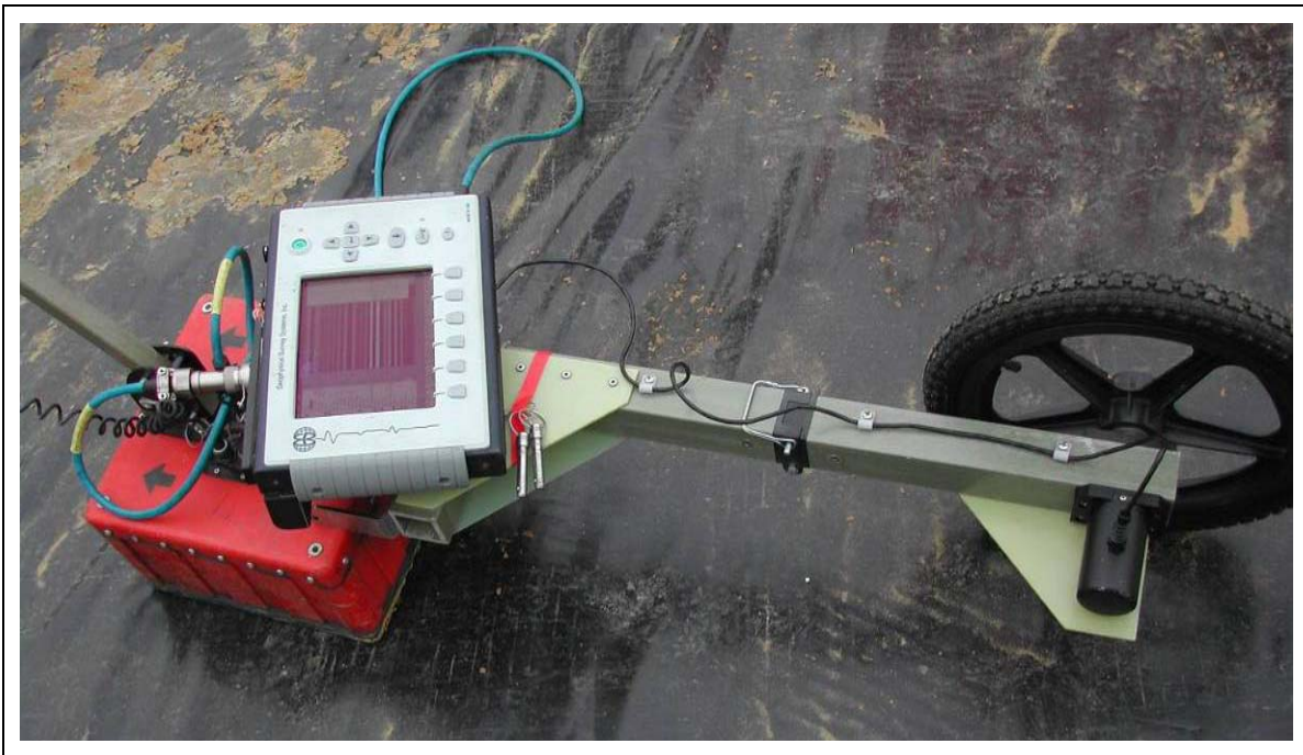
Bild 6.1: Erste Messungen mit einer 400 MHz Hornantenne
