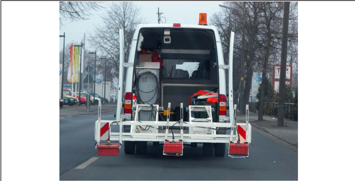
Bild 4.1 Messfahrzeug mit Hornantennen der Fa. GBM Wiebe Gleisbaumaschinen GmbH
