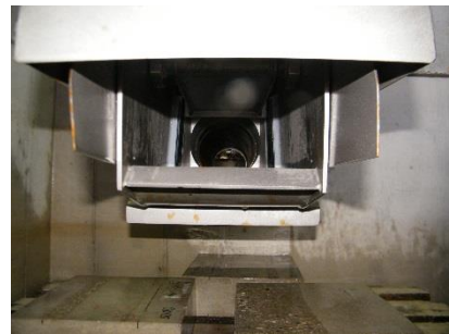
a) Abstand Düse-Drossel b) Düse schlägt gegen das Umlenkblech c) Umlenkblech ohne Schäden Bild 54 Anprallprüfung mit Kanalreinigungsdüse
