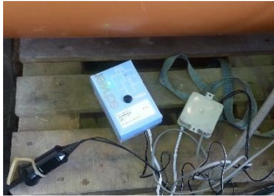
b) Steuereinheit für die Ein-/Ausschaltphasen der Maschine
