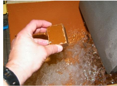
a) Durchfluss von Hygieneartikeln b) Durchfluss einer Windel c) Durchfluss einer Scherbe Bild 53 Prüfung der Verlegebeseitigung der Strahl-Drossel durch Zugabe von Hygieneartikeln und Störstoffen
