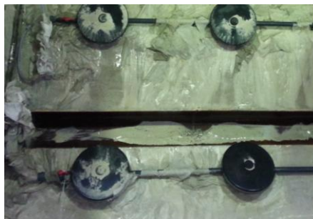
b) Ablagerungen nach dem Versuch
