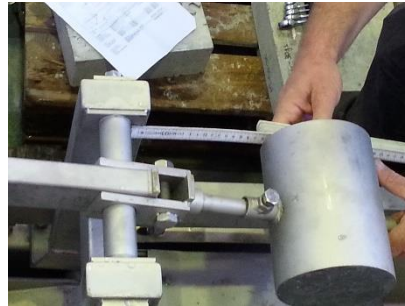
a) Lösen der Befestigungsschraube b) Verschieben des Gewichtes c) Kontrolle der Maße Bild 36 Wesentliche Arbeitsschritte für die Umstellung der Drosselwassermenge
