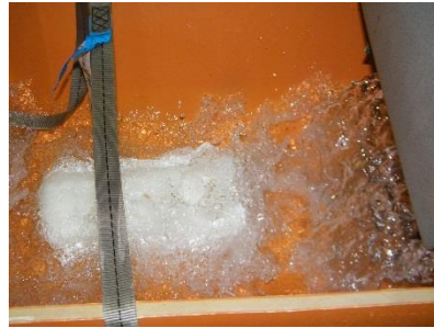
a) Durchfluss von Hygieneartikeln b) Durchfluss einer Windel c) Durchfluss einer Scherbe Bild 53 Prüfung der Verlegebeseitigung der Strahl-Drossel durch Zugabe von Hygieneartikeln und Störstoffen
