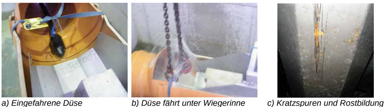
Bild 38 Anprallprüfung mit Kanalreinigungsdüse
