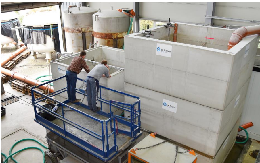
Bild 7 Versuchsanlage mit Regenbecken, Drosselbauwerk und Vorlagebehältern
