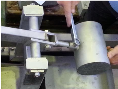
a) Lösen der Befestigungsschraube b) Verschieben des Gewichtes c) Kontrolle der Maße Bild 36 Wesentliche Arbeitsschritte für die Umstellung der Drosselwassermenge
