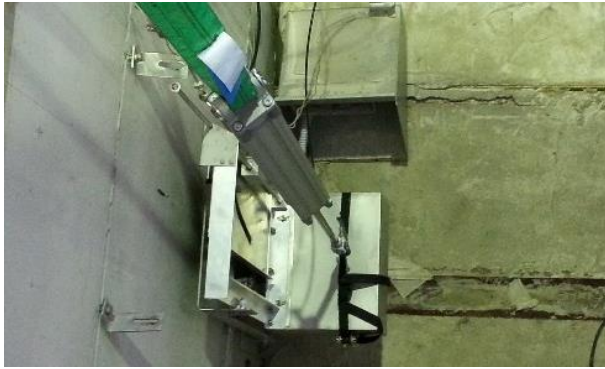
Bild 74 Versuchsaufbau für die Betriebssimulation „mechanische Belastung“
