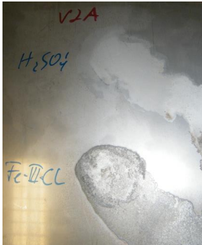
Bild 14 Mit Eisen(III)-Chlorid- ( \text{FeCl}_3 -) Lösung und Schwefelsäure ( \text{H}_2\text{SO}_4 ) beaufschlagte Oberflächen einer Vergleichsplatte aus V2A-Stahl (Stahlsorte 1.4301 entsprechend dem verwendeten Stahl aller Drosselorgane im Test): Visuell erkennbare Veränderung an der Oberfläche im Vergleich zu nicht-beaufschlagten Bereichen
