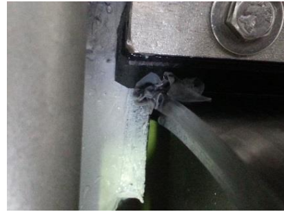
c) Schwergängigkeit durch Störkörper
