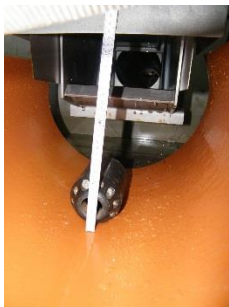
a) Abstand Düse-Drossel b) Düse schlägt gegen das Umlenkblech c) Umlenkblech ohne Schäden Bild 54 Anprallprüfung mit Kanalreinigungsdüse
