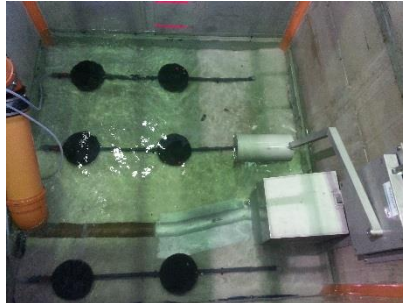
a) Voll eingestautes Regenbecken b) Drossel in Betrieb (SüwVO I) c) Wieder-Befüllen des Beckens
