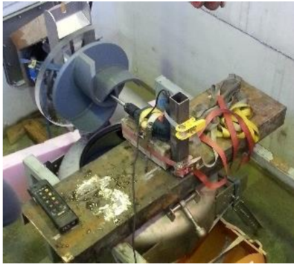
a) Antrieb des Turbinenrades
