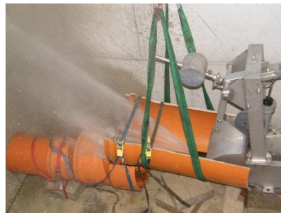
a) Abstand Düse-Drossel b) Düse schlägt gegen das Umlenkblech c) Umlenkblech ohne Schäden Bild 54 Anprallprüfung mit Kanalreinigungsdüse
