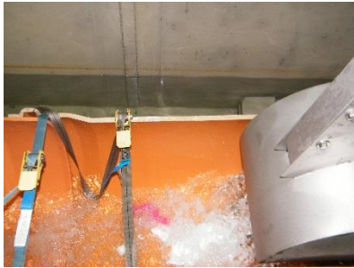
a) Durchfluss von Hygieneartikeln b) Durchfluss einer Windel c) Durchfluss einer Scherbe Bild 53 Prüfung der Verlegebeseitigung der Strahl-Drossel durch Zugabe von Hygieneartikeln und Störstoffen
