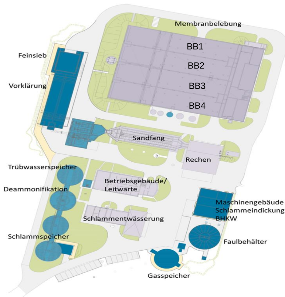
Abbildung 4.1: Lageplan des Gruppenklärwerkes Nordkanal - Stand 2021
