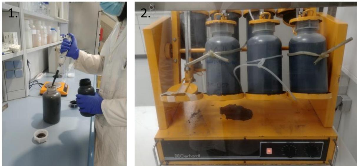
**Abbildung 6.2: (1) PAK-Dosierung; (2) Probenflaschen im Überkopfschüttler**
