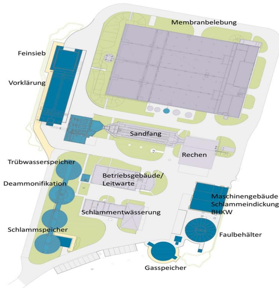
Abbildung 5.1: Lageplan des Gruppenklärwerkes Nordkanal - Stand 2021
