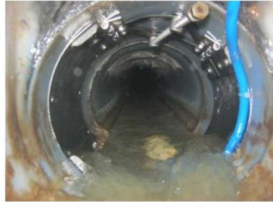
**Bild 3-4: Einrichtung Durchflussmessung**
