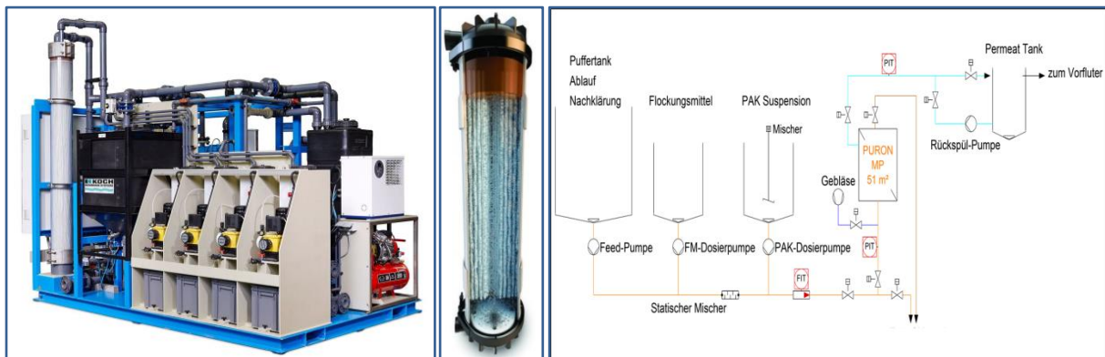
Abbildung 3: Frontansicht der Pilotanlage (Links); Modul (Mitte) und Anlagenschema der Pilotanlage (Rechts)
