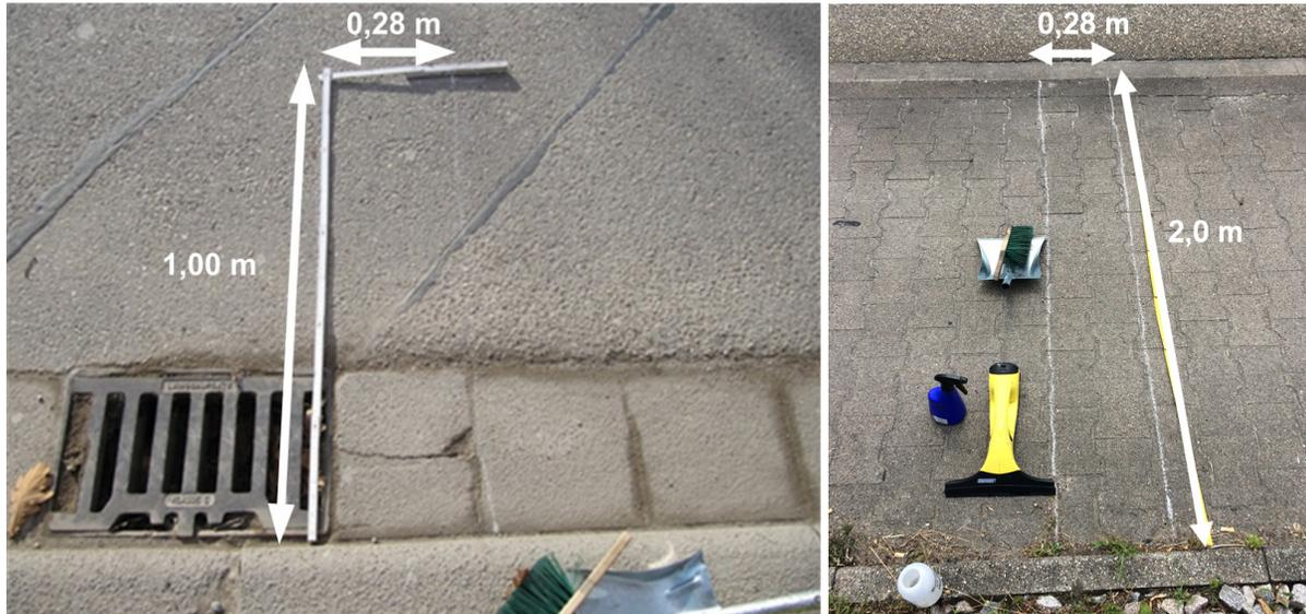
Bild 3.11: Probenahmestelle der Straßen- (links) und Gehwege (rechts)
