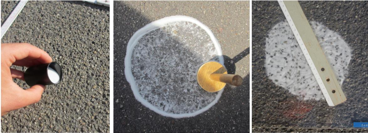
Bild 3.9: Ausbringung und Verteilung der Glaskugeln sowie Vermessung des Kreisdurchmessers Griesbaum (2017)
