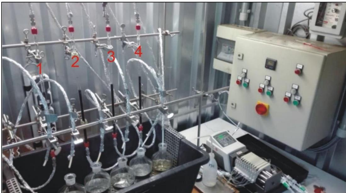
**Abbildung 5-5** Im Container aufgebaute SFT-Anlage mit vier SF Säulen (links, Nr. 1-4) und Mehrkanalschlauchpumpe (rechts)
