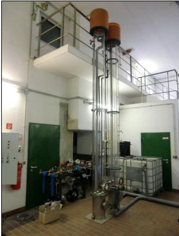
**Abbildung 5-2** Halbtechnische Adsorber auf der KA Rodenkirchen
