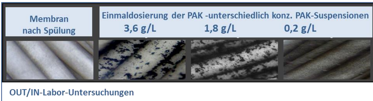
Abbildung 71: Bild aus vorhergehenden Laboruntersuchungen - gereinigte Membran sowie PAK/MF-Labormodul bei Einmaldosierung verschieden stark konzentrierter PAK-Dosiersuspensionen (Hoffmann und Panglisch, 2018)
