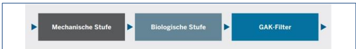
Abbildung 10: Verfahrensanordnung der GAK-Filtration nach KOM-M.NRW (2016)
