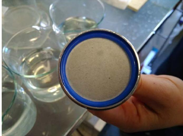
**Bild 4-2: Filterbelegung mittels Druckfiltration**
