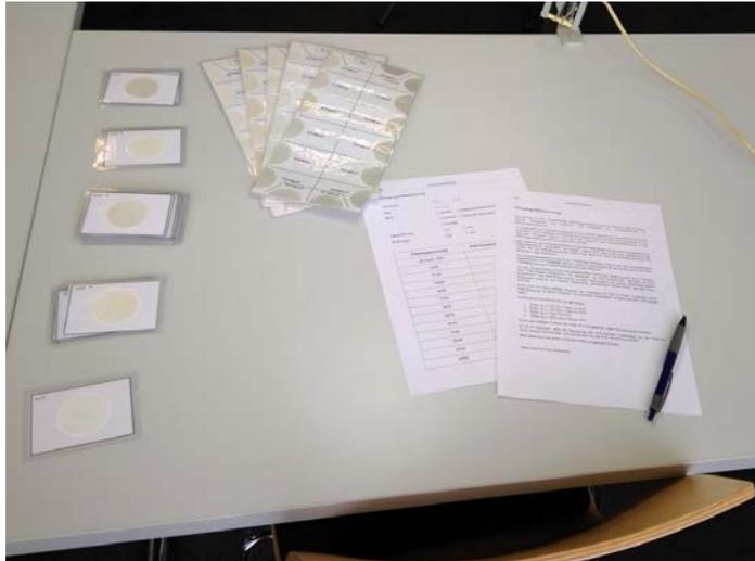
**Bild 4-8: Ausgangssituation der Probandenbefragung zur Schwarzgradbestimmung (links: zu bestimmende Filter, mitte: Referenzskalen, rechts: Informationsblatt und Vordruck zur Eintragung der Ergebnisse)**
