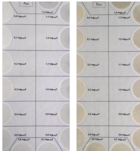
**Bild 4-7: Referenzskalen „A<sub>250</sub>“ (links) und „E<sub>250</sub>“ (rechts)**
