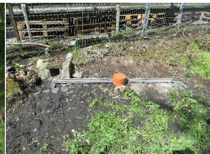
Abbildung 13: Ein Teil des Niederschlagsabflusses wird vom Einlaufpunkt abgeführt, in das PVC-Rohr geleitet und dort in einem Sammelgefäß gefasst, um die stoffliche Belastung im Zufluss zu untersuchen.
