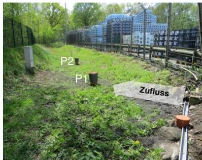
Abbildung 11: Fertigestellte Messstelle am Standort nördliches Ruhrgebiet (M2). Blick vom Einlaufpunkt (rechter Bildrand) in die Mulde. P1 und P2 bezeichnen die Messpunkte für die Sickerwasserextraktion.
