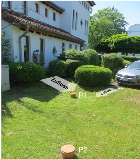
Abbildung 14: Fertiggestellte Messstelle am Standort zentrales Ruhrgebiet (M3). Der Einlaufpunkt befindet sich am Ende der Dachableitung (rechter Bildrand) und am linken Bildrand. P1 und P2 bezeichnen die Messpunkte für die Sickerwasserextraktion.
