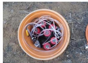
Abbildung 4: Einbau der Saugkerzen mit definiertem Winkel. Dadurch wird eine einheitliche Einbautiefe der Saugkerzen bei schrägem Einbau sichergestellt.
