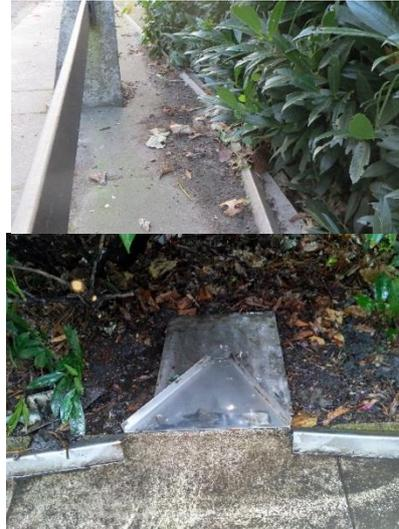
Abbildung 9: Fassung des Niederschlagsabflusses zur Beprobung der Stoffkonzentration im Zufluss (oben). Überleitung des abfließenden Wassers zum Sammelbehälter (unten). Das Sammelgefäß befindet sich unter der perforierten Metallabdeckung zum Schutz vor Eintrag von Grobstoffen.
