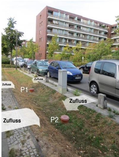
Abbildung 10: Fertiggestellte Messstelle am Standort Berlin (M1). P1 und P2 bezeichnen die Messpunkte für die Sickerwasserextraktion.
