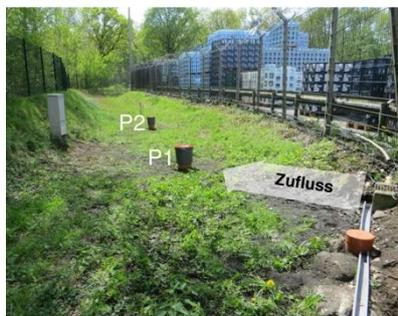
Abbildung 13: Fertiggestellte Messstelle am Standort nördliches Ruhrgebiet (M2). Blick vom Einlaufpunkt (rechter Bildrand) in die Mulde. P1 und P2 bezeichnen die Messpunkte für die Sickerwasserextraktion.
