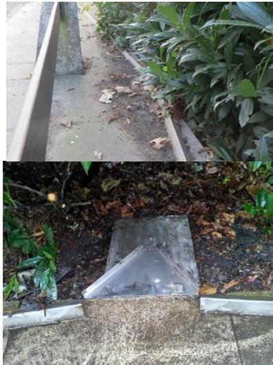
Abbildung 11: Fassung des Niederschlagsabflusses zur Beprobung der Stoffkonzentration im Zufluss (oben). Überleitung des abfließenden Wassers zum Sammelschacht (unten). Das Sammelgefäß befindet sich unter der perforierten Metallabdeckung zum Schutz vor Eintrag von Grobstoffen.
