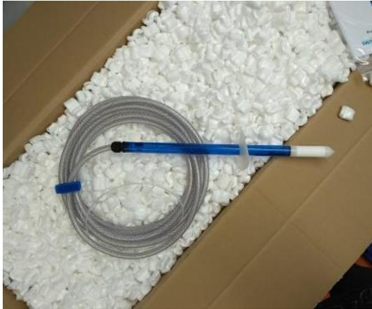
Abbildung 4: Saugkerze zur Beprobung von Sickerwasser.
