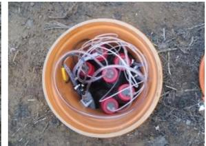
Abbildung 6: Einbau der Saugkerzen mit definiertem Winkel. Dadurch wird eine einheitliche Einbautiefe der Saugkerzen bei schrägem Einbau sichergestellt.
