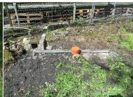
Abbildung 15: Ein Teil des Niederschlagsabflusses wird vom Einlaufpunkt abgeführt, in das PVC-Rohr geleitet und dort in einem Sammelgefäß gefasst, um die stoffliche Belastung im Zufluss zu untersuchen.
