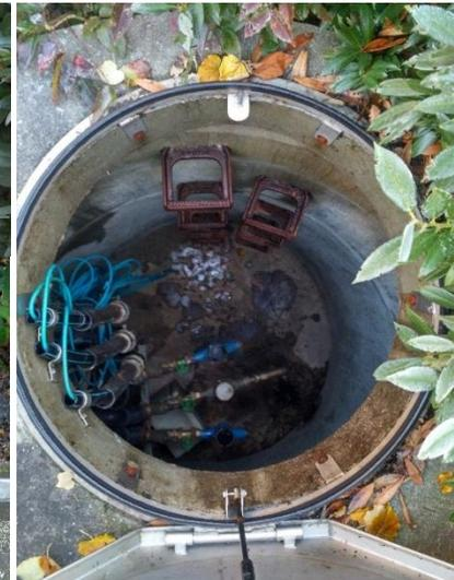
Abbildung 12: Messschacht zur Beprobung der Stoffkonzentration im Rigolenabfluss der gefassten Messmulde. Diese Messmulde schließt direkt an die Mulde mit Messstelle an (Ende der Mulde in Abbildung 10).
