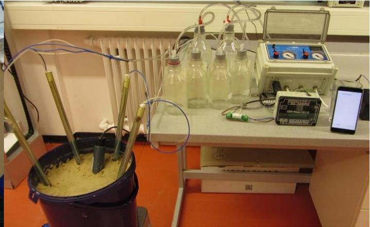
Abbildung 5: Prototyp der Messstelle. Links im Bild sind die Saugkerzen mit Bodenfeuchtesensoren zu sehen. In der Bildmitte befinden sich die Sammelgefäße für das Sickerwasser. Rechts im Bildhintergrund befindet sich die Vakuumpumpe mit dem GSM-Modul im Vordergrund zur Regelung und Fernüberwachung der Messstellen.
