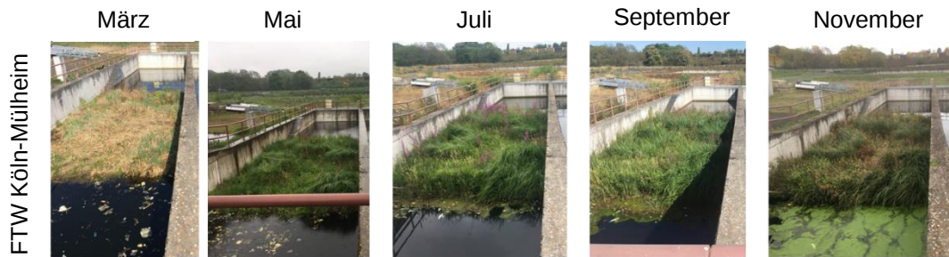
Abbildung 4.2: Pflanzenwachstum auf dem FTW in der RiStWag-Anlage Köln-Mülheim in der Zeit von März bis November 2019
