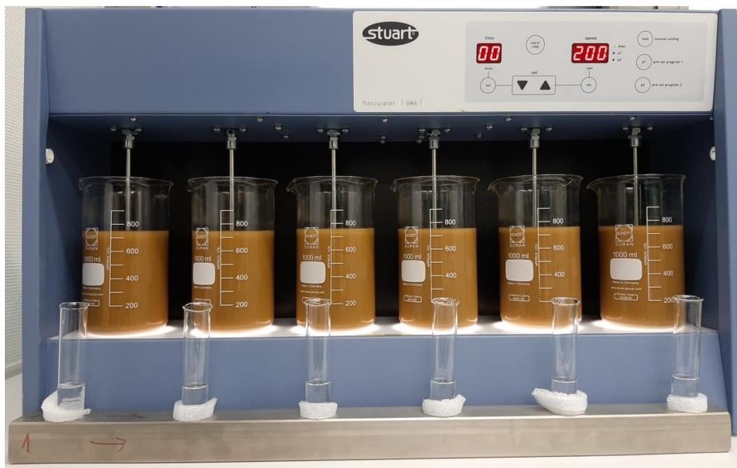
Abbildung 3-1: Flokkulator SW6 der Fa. Stuart Equipment und Reagenzglashalterung zum simultanen Zugabe des FM
