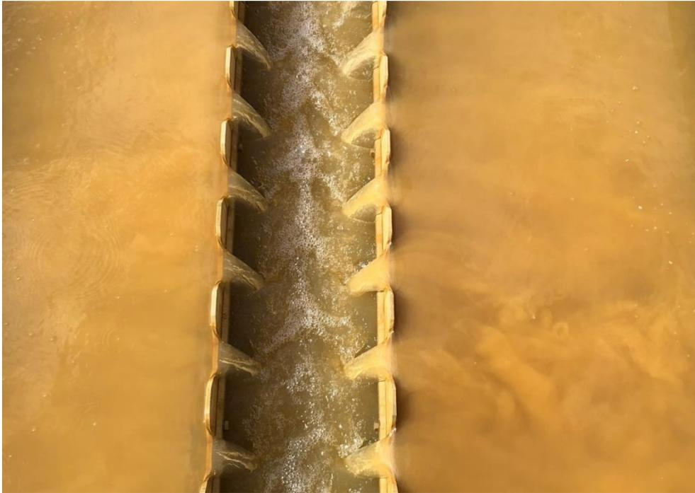
Abbildung A-14: Feldversuch in Blessem am 03.09.2019 um 11:37; Durchbruch der Flocken am Überlauf des Schrägklärers
