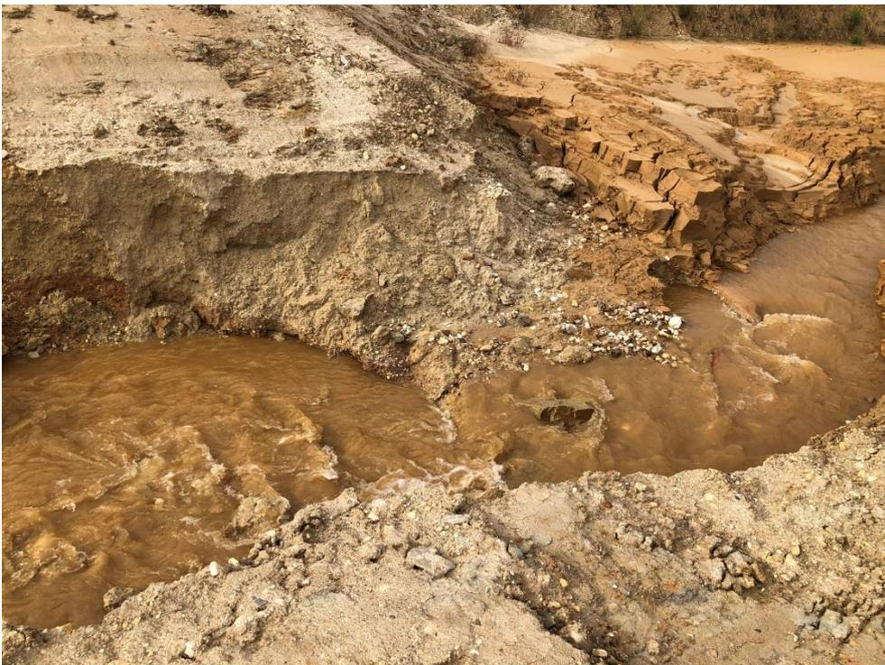
Abbildung A-11: Feldversuch in Vernich am 08.10.2019; Durchbruch im Damm zwischen den beiden Absetzbecken. Das Wasser fließt vom alten Absetzbecken (rechts im Bild) in das neue Absetzbecken
