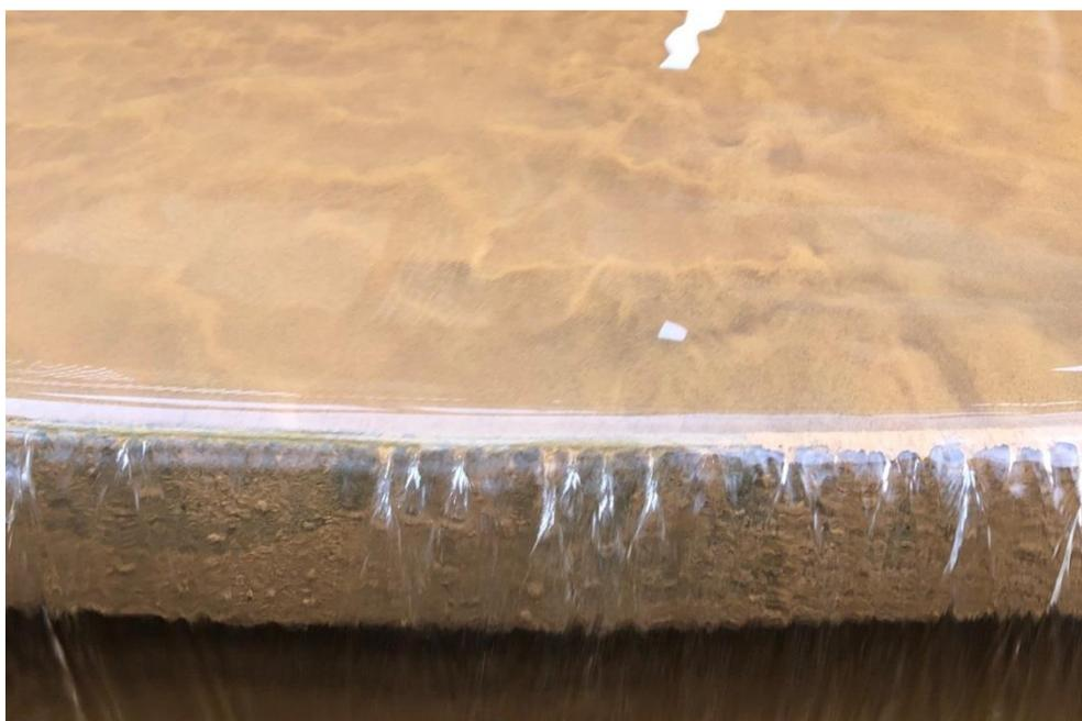
Abbildung A-8: Feldversuch in Gymnich am 20.03.2019 um 08:55, Durchbruch der Flocken am Überlauf des Triplexklärers
