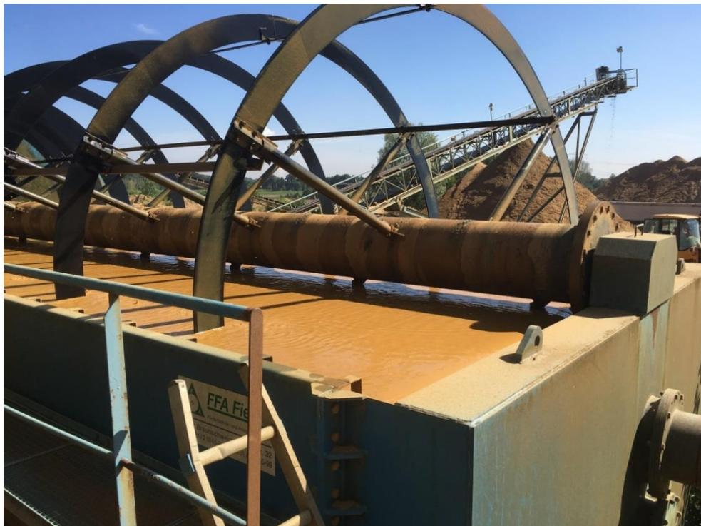
Abbildung A-1: Sandfang der Kieswäsche Buir; Probenahmestelle für KWW zur Durchführung der Voruntersuchungen im Labor
