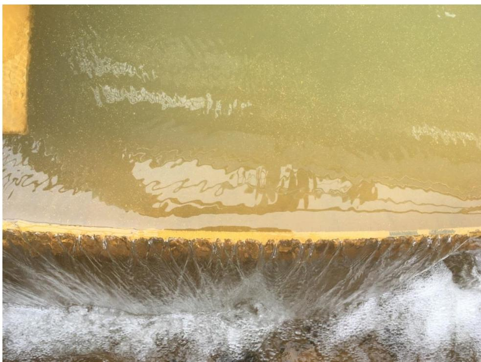
Abbildung A-6: Überlauf des Triplexklärers der Kieswäsche Gymnich
