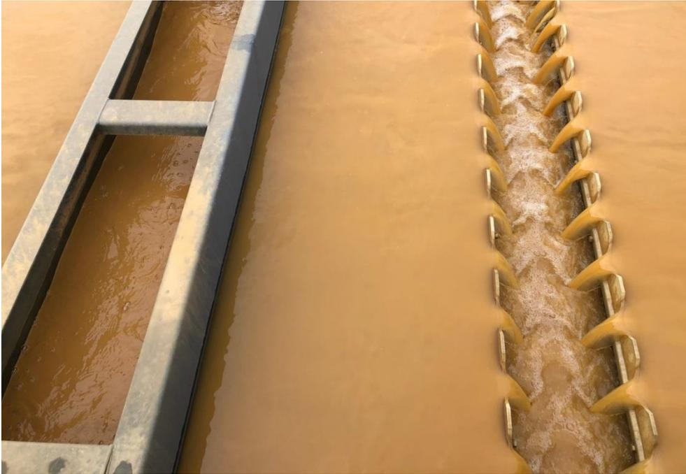
Abbildung A-16: Feldversuch in Blessem am 03.09.2019 um 13:15; Unzureichende Klärung des KWW bei 125 t/h Rohstoffaufgabe und 350 m<sup>3</sup>/h Waschwasser
