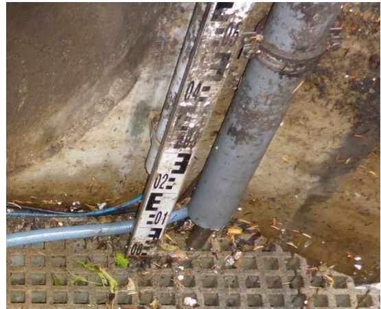
Bild 6: Füllstandsmessung im Zulauf der Filteranlage „In der Fleute“
