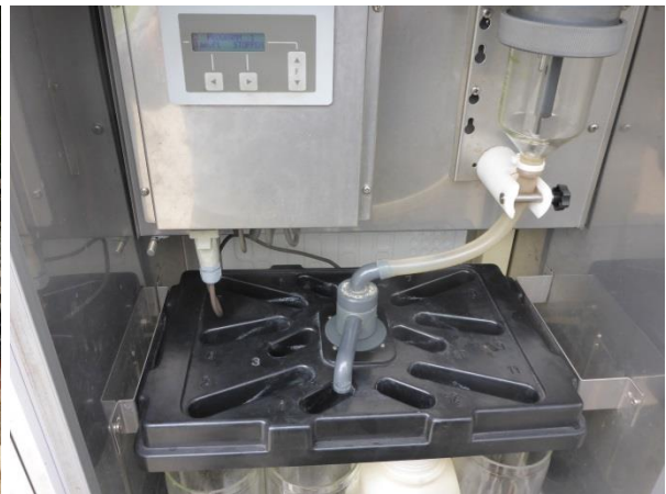
Bild 13: Probenehmer (Fa. Bühler) auf dem Betriebsgelände der Filteranlage
