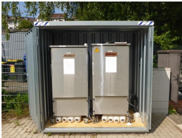
Bild 13: Probenehmer (Fa. Bühler) auf dem Betriebsgelände der Filteranlage
