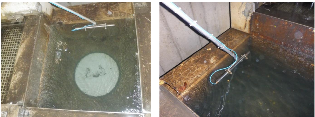
Bild 10: Anordnung der Photometersonde im Ablaufbereich
