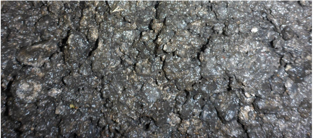
Bild 23: Detailansicht des verunreinigten Filtermaterials beim Ausbau am 07.07.2015
