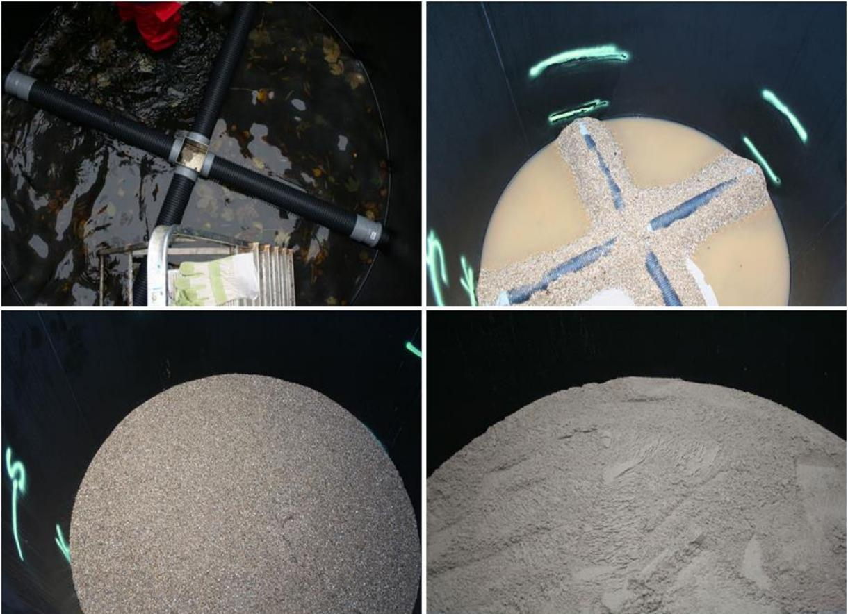
**Abbildung 3.4: Schichtenaufbau der Versuchsfilter**
