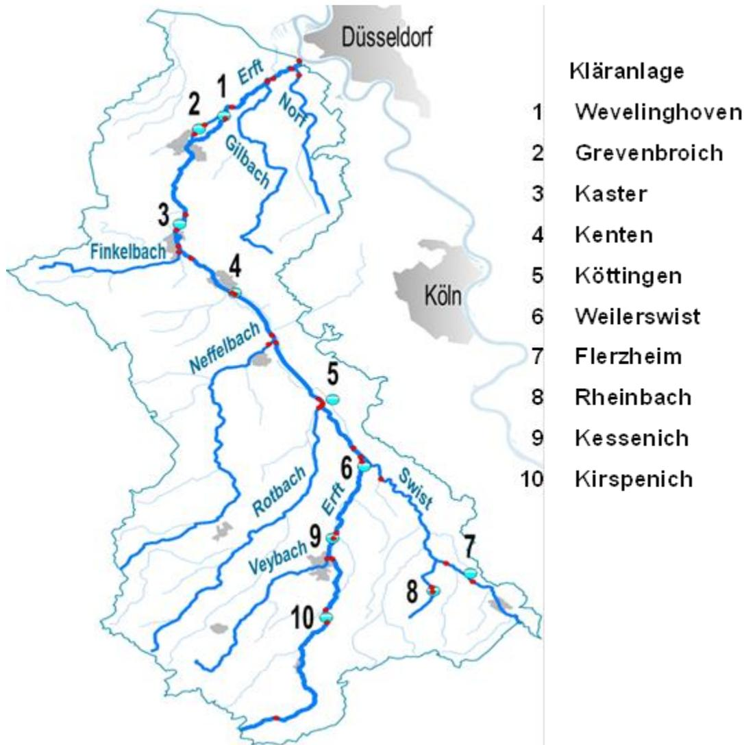
Abbildung 1: Untersuchte Kläranlagenstandorte (blau) und Probenahmepunkte am Gewässer (rot)
